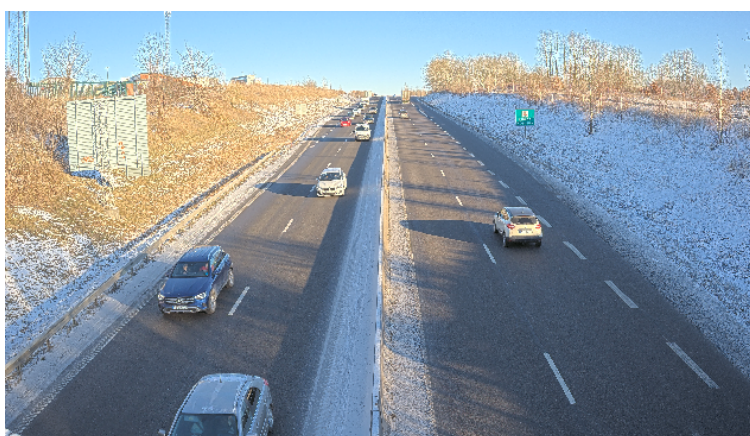
Escena de vigilancia del tráfico, grabada con la AXIS Q1728 Block Camera. Velocidad de bits con AV1: un 24 % menor en comparación con H.264 y un 0,72 % menor en comparación con H.265.
