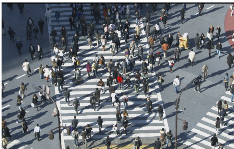
Cena de monitoramento urbano movimentado, extraída de um vídeo de sequência de teste padrão. Taxa de bits com AV1: -33% em comparação com o H.264, -5,8% em comparação com o H.265.
