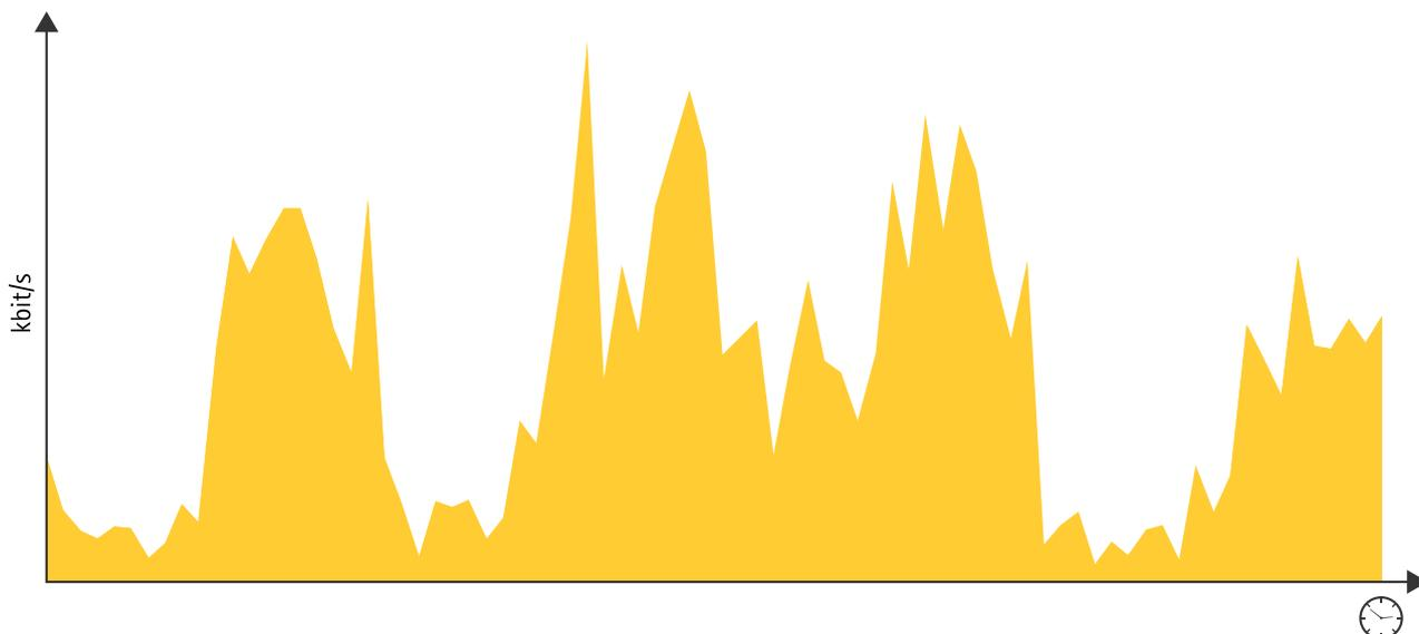
Figure 4.1 Avec VBR, le débit binaire peut varier, avec pour résultat une qualité d'image intacte, mais aussi des besoins en stockage non prévisibles.
