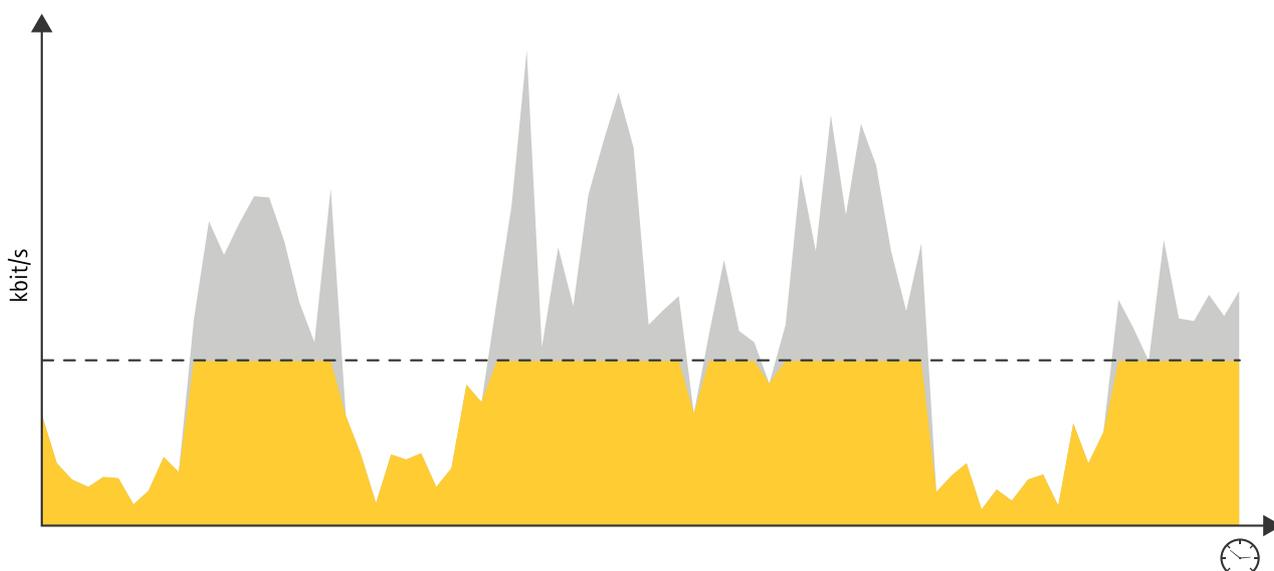
Figure 5.1 MBR, représenté ici avec une limite de débit binaire basse. Les besoins en stockage seront prévisibles, mais la perte d'informations peut être considérable dans les scènes complexes.
