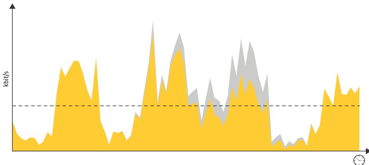
Figure 3.1 Avec ABR, il est possible de maintenir une qualité d'image élevée pendant les pics d'activité grâce aux économies réalisées pendant les périodes antérieures plus calmes. Moyenné sur une période donnée, l'objectif de débit binaire doit être respecté.
