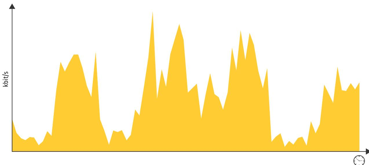
Figura 4.1 Con VBR, la velocità di trasmissione può variare: il risultato è una qualità d'immagine senza compromessi, ma anche uno spazio di archiviazione impossibile da prevedere.
