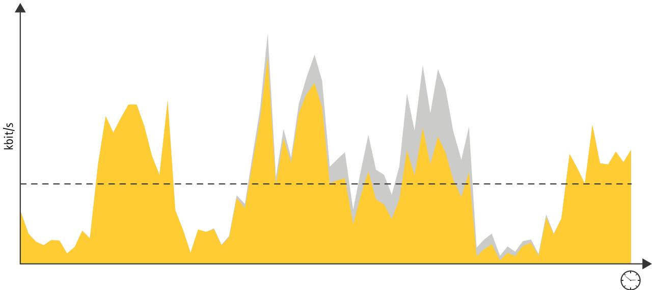
Figura 3.1 Con ABR, è possibile mantenere una qualità d'immagine elevata durante i picchi grazie ai risparmi ottenuti nei periodi precedenti e meno attivi. È necessario rispettare la velocità di trasmissione impostata, mediata in un periodo di tempo prestabilito.
