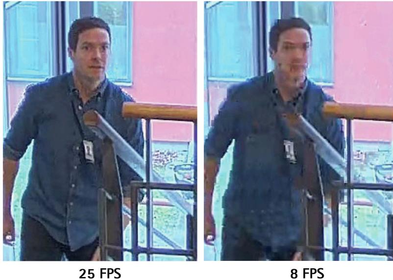
図 2.1 動きの多い広範なシーンを捉えたビデオから切り取ったスナップショット。ABR方式では、非常に静かなシーンで短時間に動きが発生した場合にはるかに高い瞬間ビットレート（約4000 kbps）が可能となるため、ABRでエンコードされたビデオの画質とフレームレートのほうが大幅に優れています。
