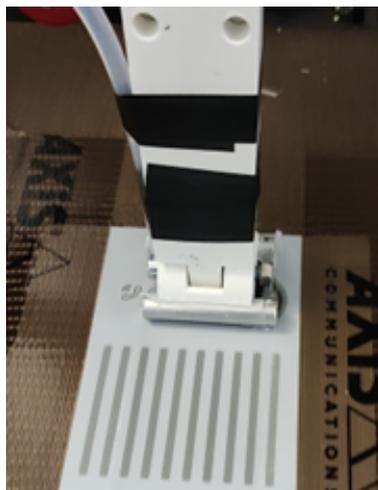
*Equipos utilizados para la simulación de limpieza. Las muestras se limpiaban con un paño montado en un brazo móvil automático. Periódicamente se volvía a aplicar el producto químico en el paño.*
