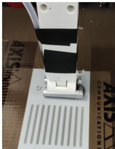
クリーニングシミュレーションの実施方法。自動可動アームに取り付けられた布で、サンプルを拭き取ります。定期的に布を化学溶液で湿らせてください。
