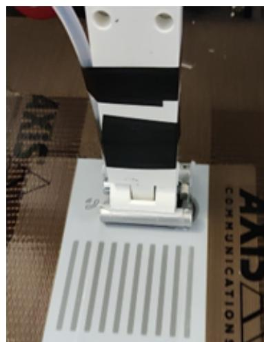
*Configuração da simulação de limpeza. As amostras foram limpas com um pano montado em um braço móvel automático. O pano era regularmente embebido com o produto químico.*
