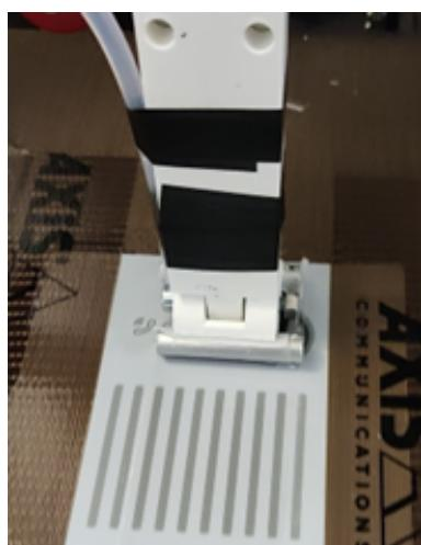
清洁模拟的相关布置。用固定在自动活动臂上的软布擦拭试样。此布定期用选定化学品浸透。
