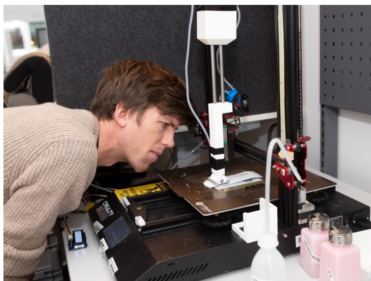
Figure 2. Aufbau für die Reinigungssimulation Die Proben werden mit einem Tuch abgewischt, dass an einem automatischen, beweglichen Arm befestigt ist.
