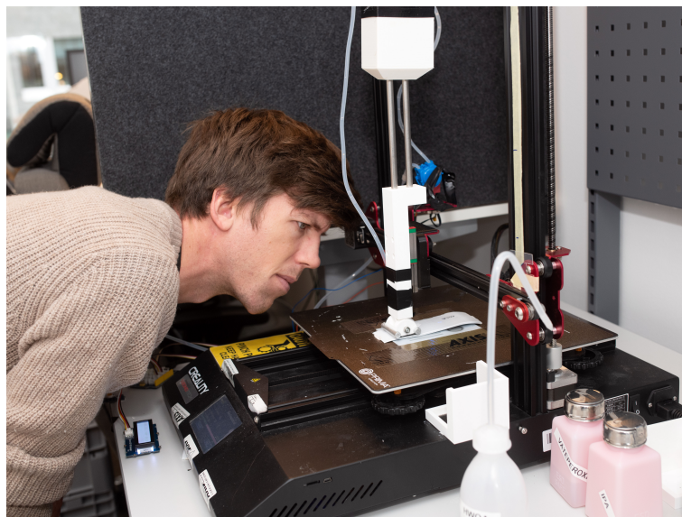
Abbildung 3.2 Aufbau für die Reinigungssimulation Die Proben werden mit einem Tuch abgewischt, dass an einem automatischen, beweglichen Arm befestigt ist.
