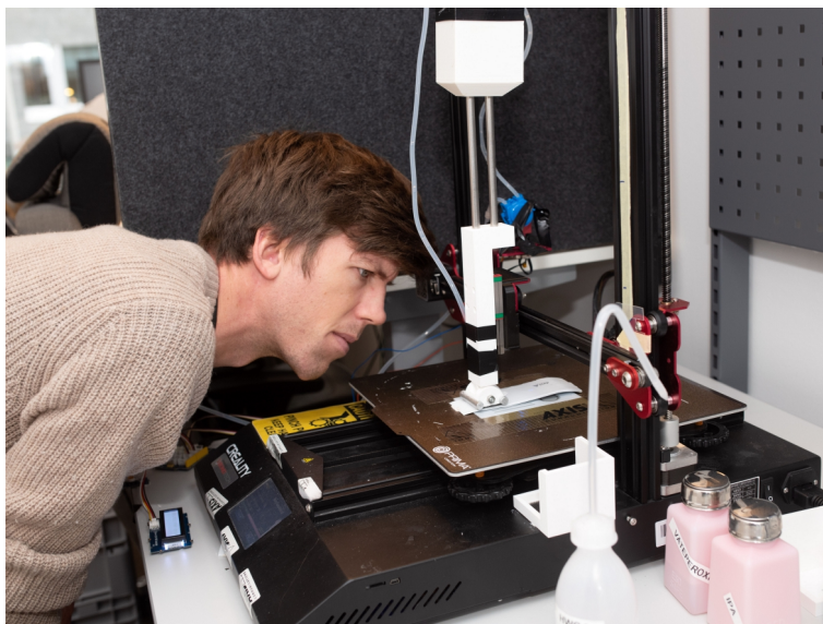
Figure 2. Equipos utilizados para la simulación de limpieza. Las muestras se limpiaban con un paño montado en un brazo móvil automático.
