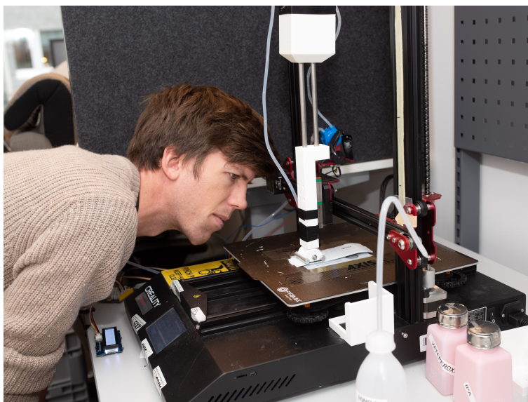
Figure 3.2 Installation pour la simulation de nettoyage. Les échantillons sont essuyés avec un chiffon fixé à un bras mobile automatique.
