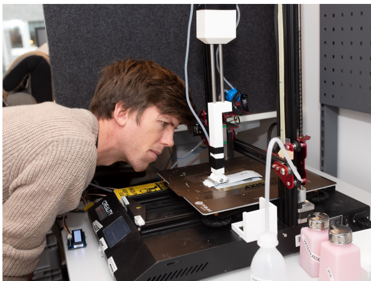
Figure 2. Stanowisko do symulacji czyszczenia. Elementy są przecierane szmatką zamontowaną na automatycznym ruchomym ramieniu.
