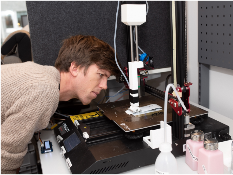
Figure 2. 清洁模拟的相关布置。用固定在自动活动臂上的布擦拭试样。
