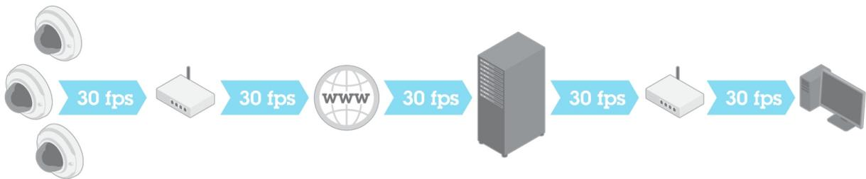
*Figure 1. Un sistema de vigilancia con una velocidad de fotogramas controlada de 30 fps en cada paso. La velocidad de fotogramas de la cámara únicamente puede mantenerse en todo el sistema si el rendimiento global del sistema es suficiente.*
