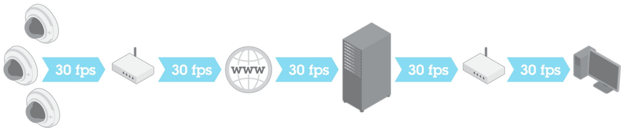
Figure 1. 每个阶段都具有30 fps可控帧速的监控系统。只有在整体系统性能充足的情况下，摄像机的帧速才能在整个系统中得以保持。
