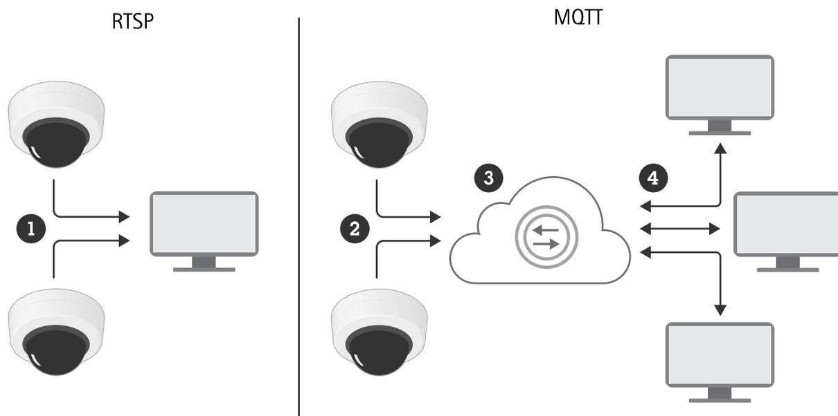
Alors que le protocole RTSP se limite aux communications un-à-un, MQTT permet également les communications un-à-plusieurs et plusieurs-à-plusieurs par l'intermédiaire du broker.
