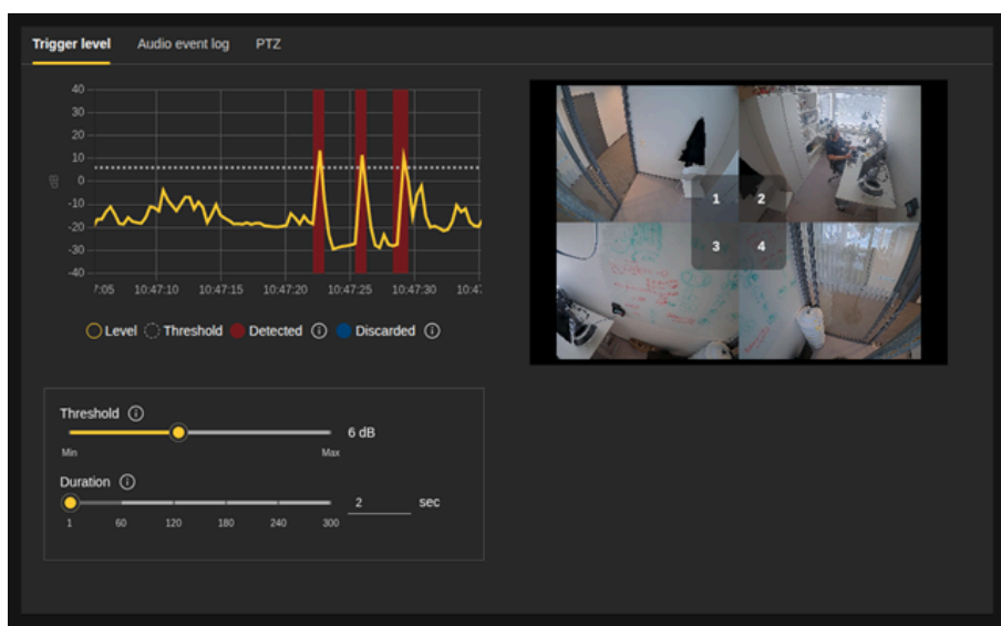
Figura 4.1 La interfaz web con vista cuádruple desde las cámaras generales y controles deslizantes para ajustar el umbral y la duración de la detección.
