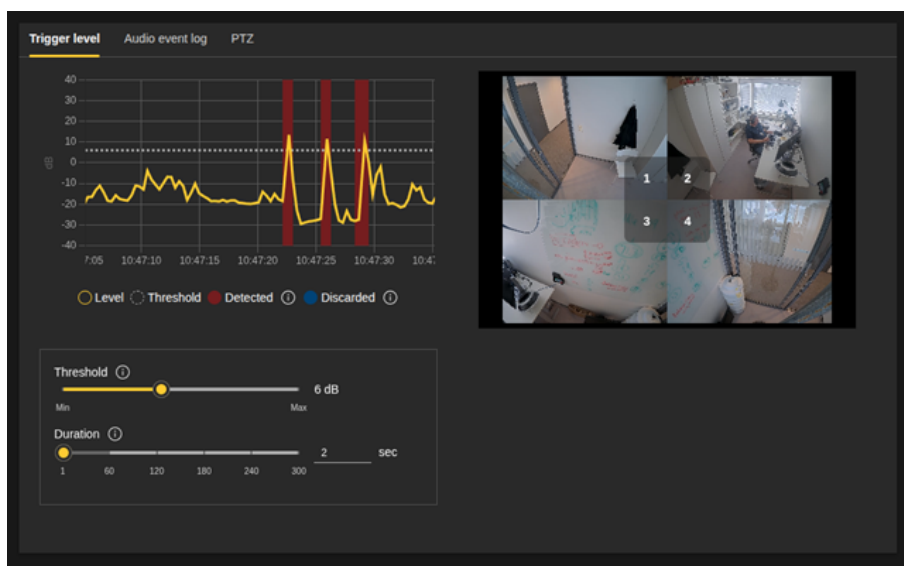
Figure 4.1 L'interface web avec affichage de la vue quadravision des caméras de vue d'ensemble et les curseurs pour paramétrer le seuil et la durée de détection.
