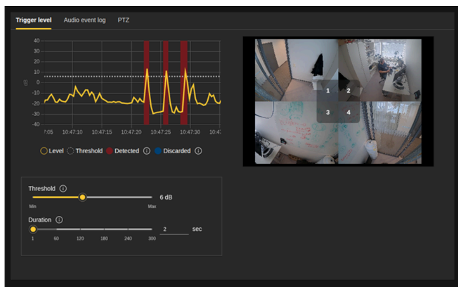
Figura 4.1 Interfaccia web con visualizzazione a quad dalle telecamere panoramiche e cursori per le impostazioni della soglia di rilevamento e della durata.
