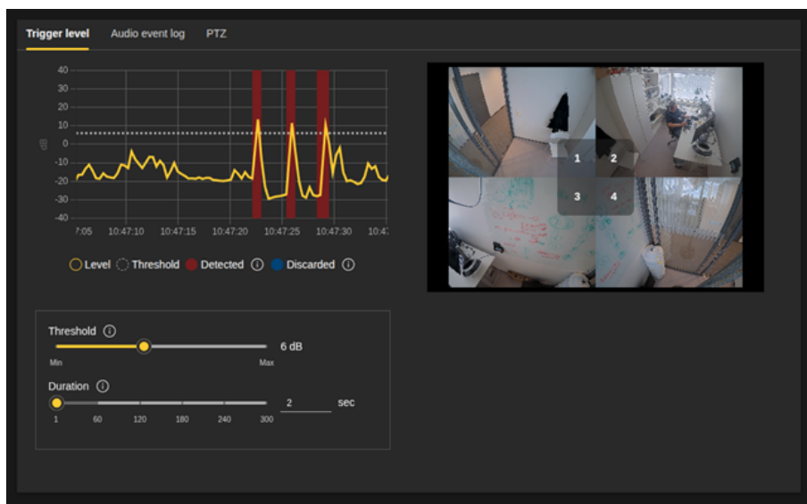
Ilustracja 4.1 Interfejs WWW z widokiem poczwórnym z kamer i suwaki do ustawienia progu detekcji i czasu trwania.
