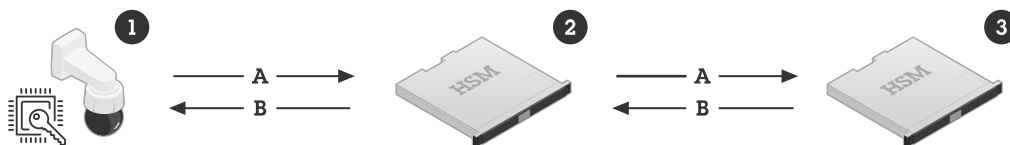
Figure 5. Infrastructure à clés publiques (PKI) IEEE 802.1AR Axis pour le provisionnement en usine de l'identifiant de périphérique Axis pendant le processus de fabrication. L'ID de dispositif Axis (1), qui est un certificat intégrant le numéro de série du produit, est signé par une CA intermédiaire d'ID de dispositif Axis (2), elle-même signée par la CA racine de l'ID de dispositif Axis (3). Des modules matériels de sécurité (HSM) spécialisés sont utilisés pour le provisionnement sécurisé en usine.
