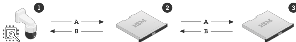
Figure 5. 製造工程でAxisデバイスIDを工場でのプロビジョニングできるように、AxisはIEEE 802.1ARに準拠した公開鍵インフラストラクチャー (PKI) を実装しています。製品のシリアル番号が組み込まれた証明書であるAxisデバイスID (1) は、AxisデバイスID中間CA (2) によって署名され、この中間CAはAxisデバイスIDルートCA (3) によって署名されます。専用のハードウェアセキュリティモジュール (HSM) は、工場での安全なプロビジョニングに使用されます。
