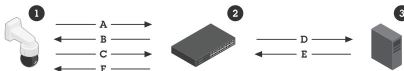
Figure 8. オンボーディングプロセスに関する詳細説明。安全なデバイスIDのIEEE 802.1ARには、RADIUSサーバー(3)を使用して、IEEE 802.1X EAP要求(EAP-TLS)経由でデバイス(1)を識別し、ネットワークへのデバイスアクセスを許可する方法が定義されています。
