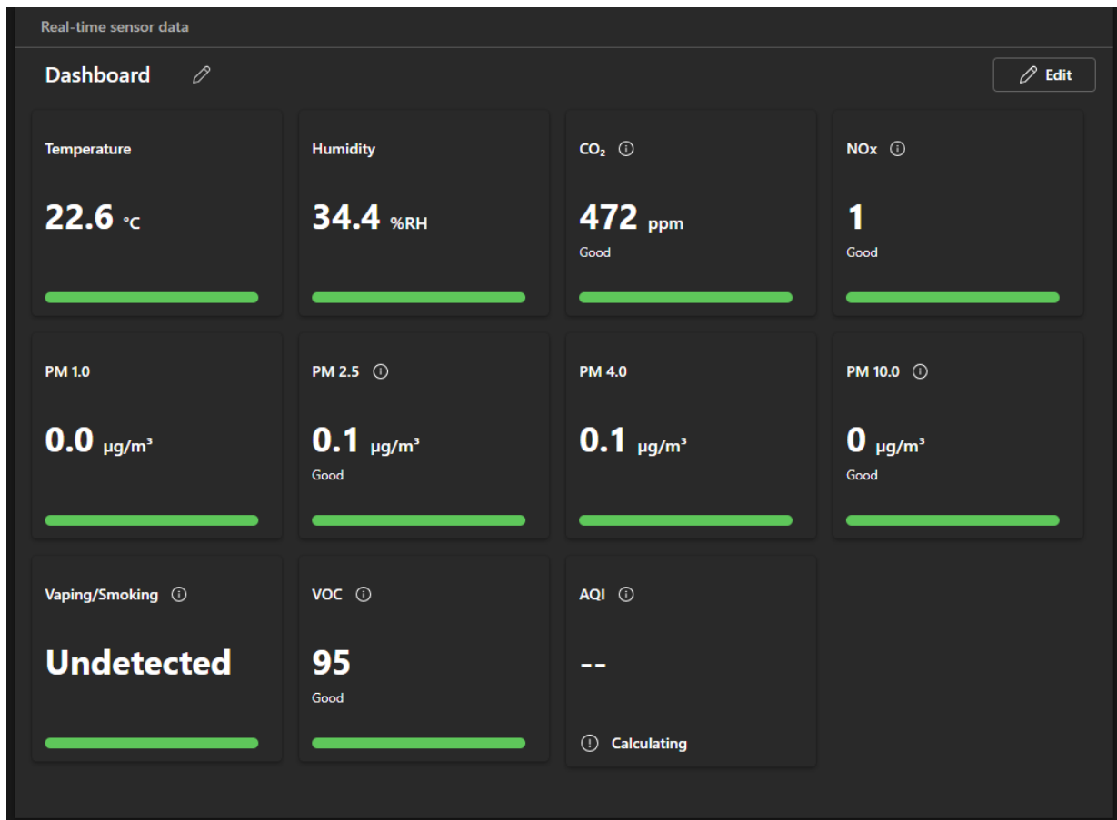
Dashboard mit Live-Messdaten eines Luftqualitätssensors von Axis.
