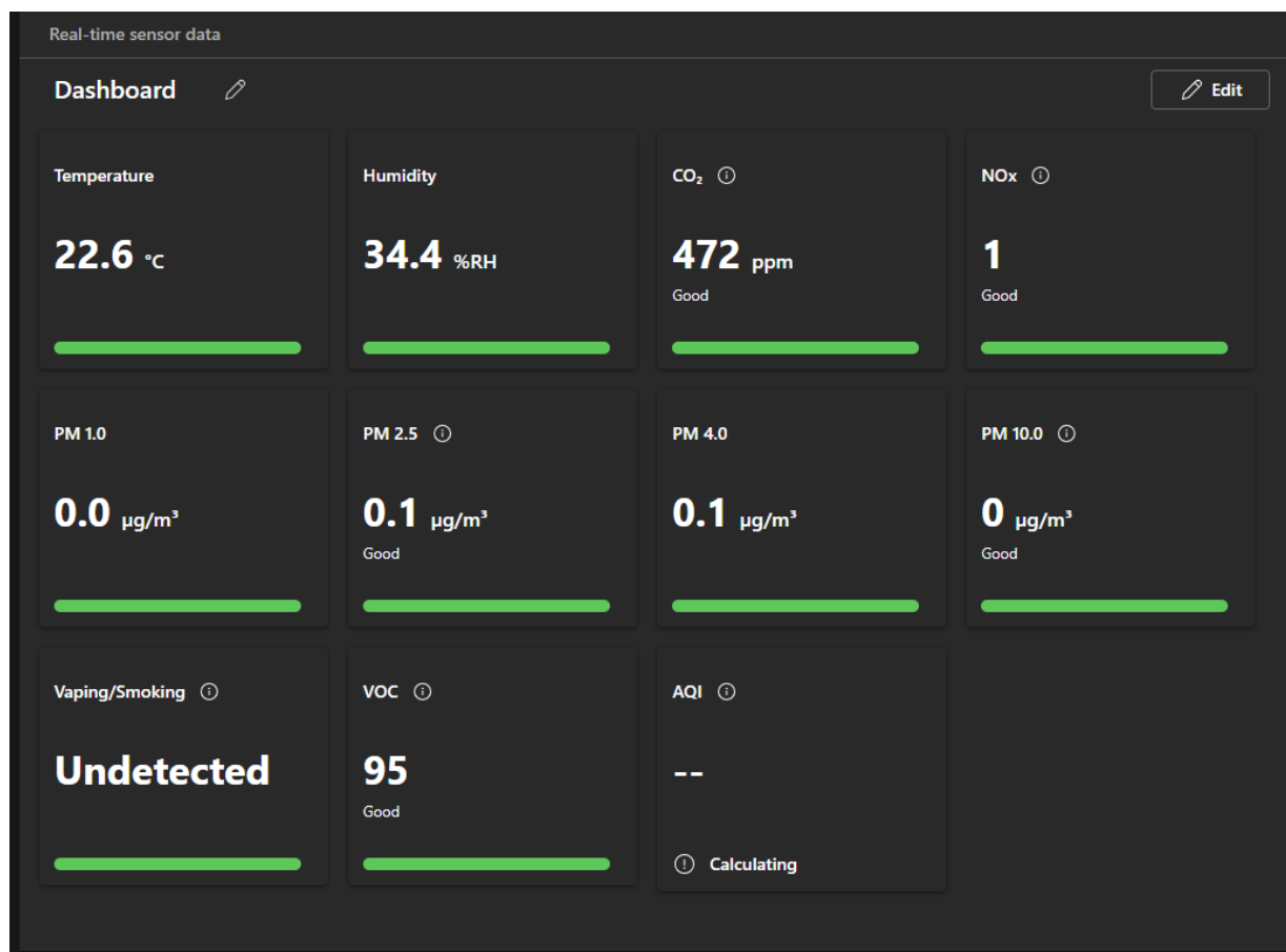
Panel de control que recoge datos de medición en tiempo real de un sensor de calidad del aire Axis.
