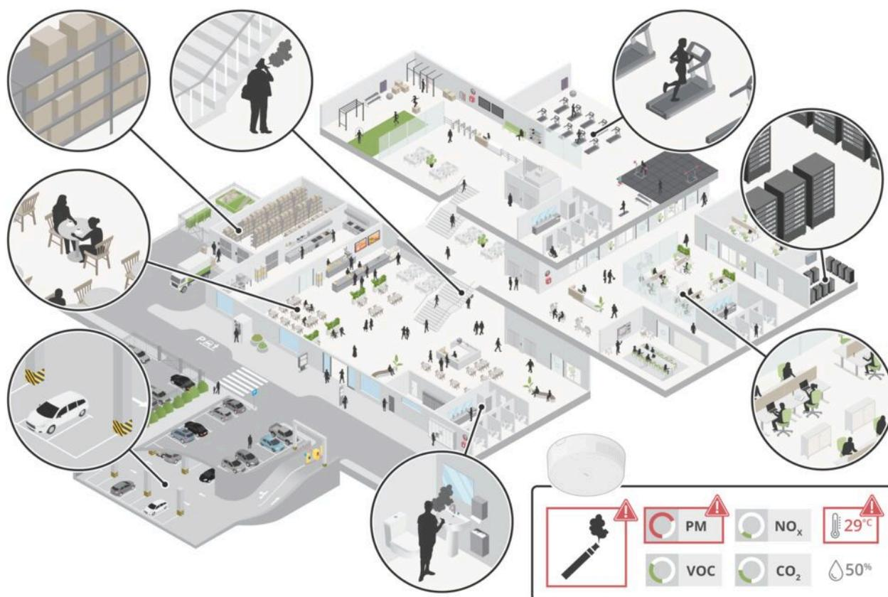
*I sensori di qualità dell'aria sono tipicamente utilizzati per monitorare i parametri di qualità dell'aria interna negli uffici e nelle aree pubbliche, per monitorare la temperatura e l'umidità nelle sale server e per rilevare il fumo o il vapore delle sigarette elettroniche nei bagni e nelle scale.*
