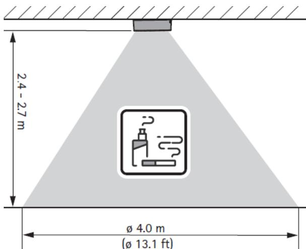
*Copertura di un sensore montato a soffitto per il rilevamento del fumo o del vapore delle sigarette elettroniche.*
