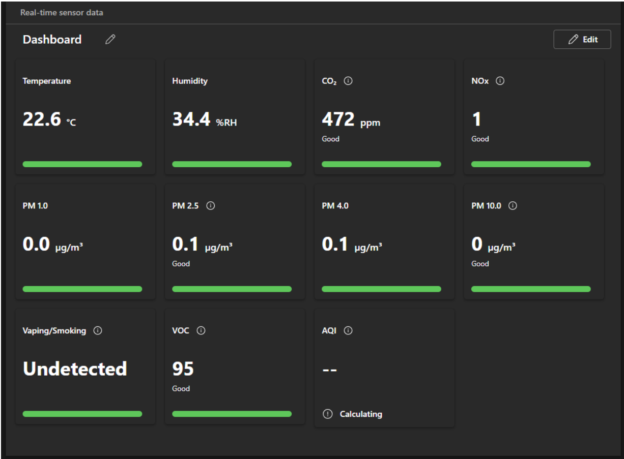
仪表盘显示安讯士空气质量传感器的实时测量数据。
