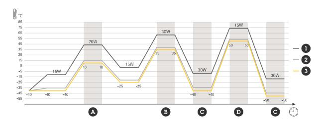
Mediciones de temperatura, junto con la potencia consumida típica, con diferentes temperaturas ambiente.
