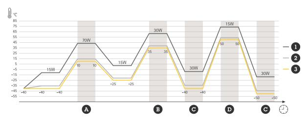
さまざまな周囲温度における温度変化の測定と一般的な消費電力。 1 ミッドスパンの内部温度
