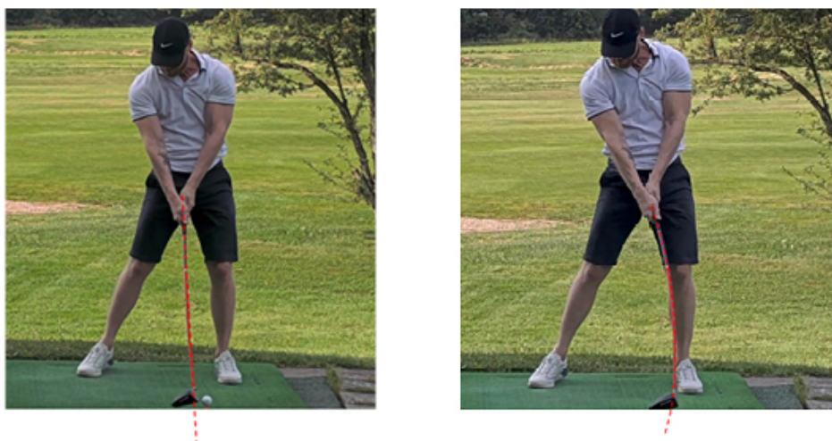
Abbildung 3.2 Ein Golfschwung, der im selben Moment mit einer Rolling-Shutter-Kamera (links) und einer Global-Shutter-Kamera (rechts) aufgenommen wurde. Bei der Rolling-Shutter-Kamera wirkt der Schläger aufgrund der Rolling-Shutter-Verzerrung verbogen. Beide Kameras sind auf sehr kurze Belichtungszeiten von 1/10000 s eingestellt, um Bewegungsunschärfe zu minimieren.
