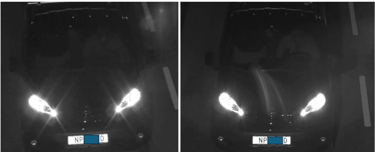
Abbildung 9.3 Das Fahrzeug wurde mit einer Rolling-Shutter-Kamera und einer Global-Shutter-Kamera bei kurzer Belichtungszeit ( 1/1000 s) aufgenommen. Da die Bewegung im Bild sehr langsam ist, treten keine Rolling-Shutter-Verzerrungen auf. Aus diesem Blickwinkel ist der Rolling-Shutter nicht zu sehen.
