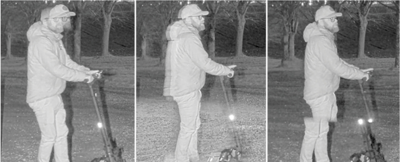
Abbildung 9.1 Eine Rolling-Shutter-Kamera mit langer Belichtungszeit (1/30 s) neben einer Global-Shutter-Kamera mit blinkendem Infrarotlicht im WDR-Modus. Im WDR-Modus erfolgen pro Bild zwei IR-Blitze in sehr kurzem zeitlichen Abstand. Die beiden Impulse führen bei der Rolling-Shutter-Kamera zu seltsamen Bildartefakten, wie beispielsweise Doppelbildern oder abgeschnittenen Bildern von sich bewegenden Objekten.
