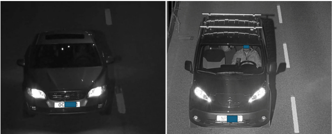
Abbildung 5.2 Das erste Bild zeigt eine Momentaufnahme eines Fahrzeugs, das mit einem Rolling-Shutter-Sensor und einem kontinuierlich strahlenden IR-Strahler mit einer Leistungsaufnahme von 25 W aufgenommen wurde. Das zweite Bild wurde mit einem Global-Shutter-Sensor und einem blinkenden IR-Strahler mit einer Leistungsaufnahme von 20 W und einer Spitzenleistung von 500 W aufgenommen. Der Einsatz eines Global-Shutter-Sensors in Verbindung mit blinkendem Infrarotlicht kann die Erkennbarkeit erheblich verbessern.
