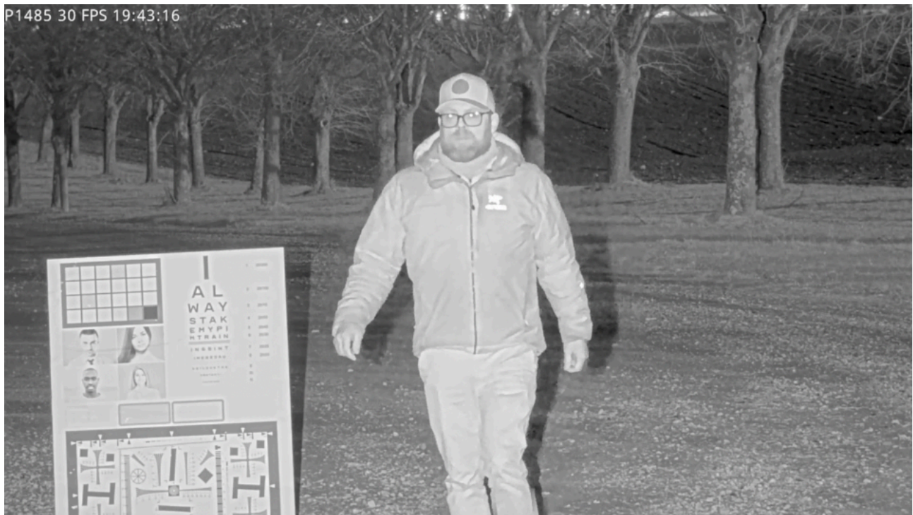
Figura 6.1 Una cámara con obturador basculante, tiempo de exposición prolongado (1/30 s) y flash infrarrojo breve (1/1 000 s). En este caso, la luz de infrarrojos es visible en la imagen completa, ya que el destello se produce en el intervalo de tiempo en el que todas las filas del sensor están expuestas simultáneamente a la luz.
