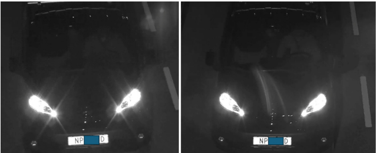
Figura 9.3 Vehículo fotografiado con una cámara con obturador basculante y una cámara con obturador global, con un tiempo de exposición breve ( 1/1\,000 s). Dado que el movimiento a través de la imagen es muy lento, no hay distorsión por obturador basculante. Desde este ángulo, el obturador basculante no es visible.
