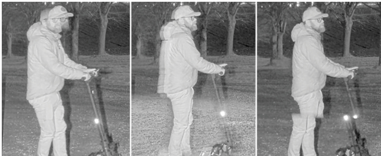
Figura 9.1 Una cámara con obturador basculante y un tiempo de exposición prolongado (1/30 s) junto a una cámara con obturador global y luz de infrarrojos estroboscópica en modo WDR. En el modo WDR, se producirán dos destellos de infrarrojos por fotograma, con muy poca diferencia de tiempo entre ellos. Estos dos impulsos provocan extraños artefactos en la imagen de la cámara con obturador basculante, como imágenes dobles o imágenes recortadas de objetos en movimiento.
