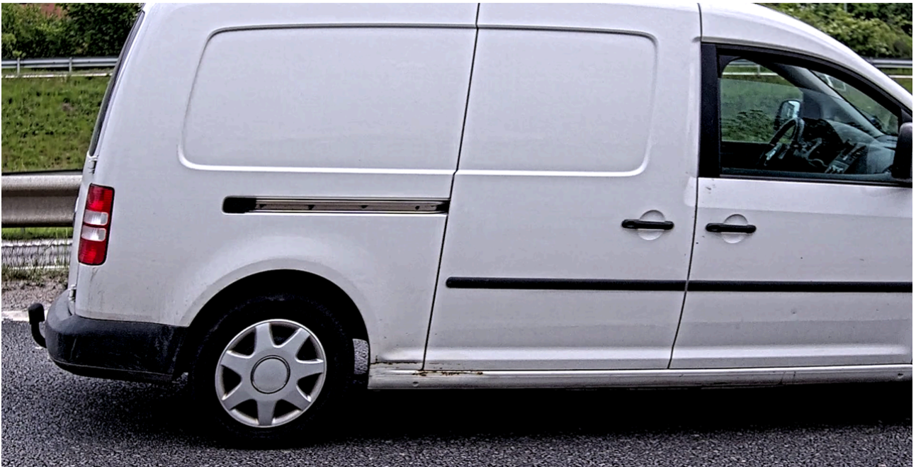
Figura 3.3 Un vehículo que avanza rápidamente por la imagen se mostrará inclinado debido a la distorsión del obturador basculante.
