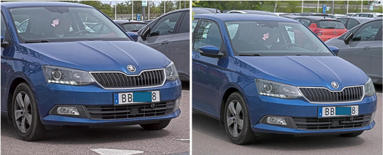
Figura 9.3 Vehículo fotografiado con una cámara con obturador basculante y una cámara con obturador global, con un tiempo de exposición breve ( 1/1\,000 s). Dado que el movimiento a través de la imagen es muy lento, no hay distorsión por obturador basculante. Desde este ángulo, el obturador basculante no es visible.
