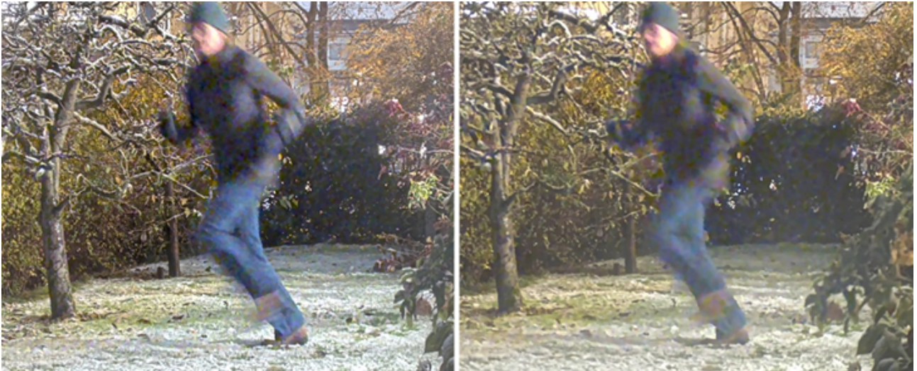
Figure 9.5 Individu courant, filmé de nuit par une caméra à obturateur progressif et une caméra à obturateur global avec temps d'exposition long ( 1/25 s). Le temps d'exposition long provoque du flou de mouvement avec les deux caméras.
