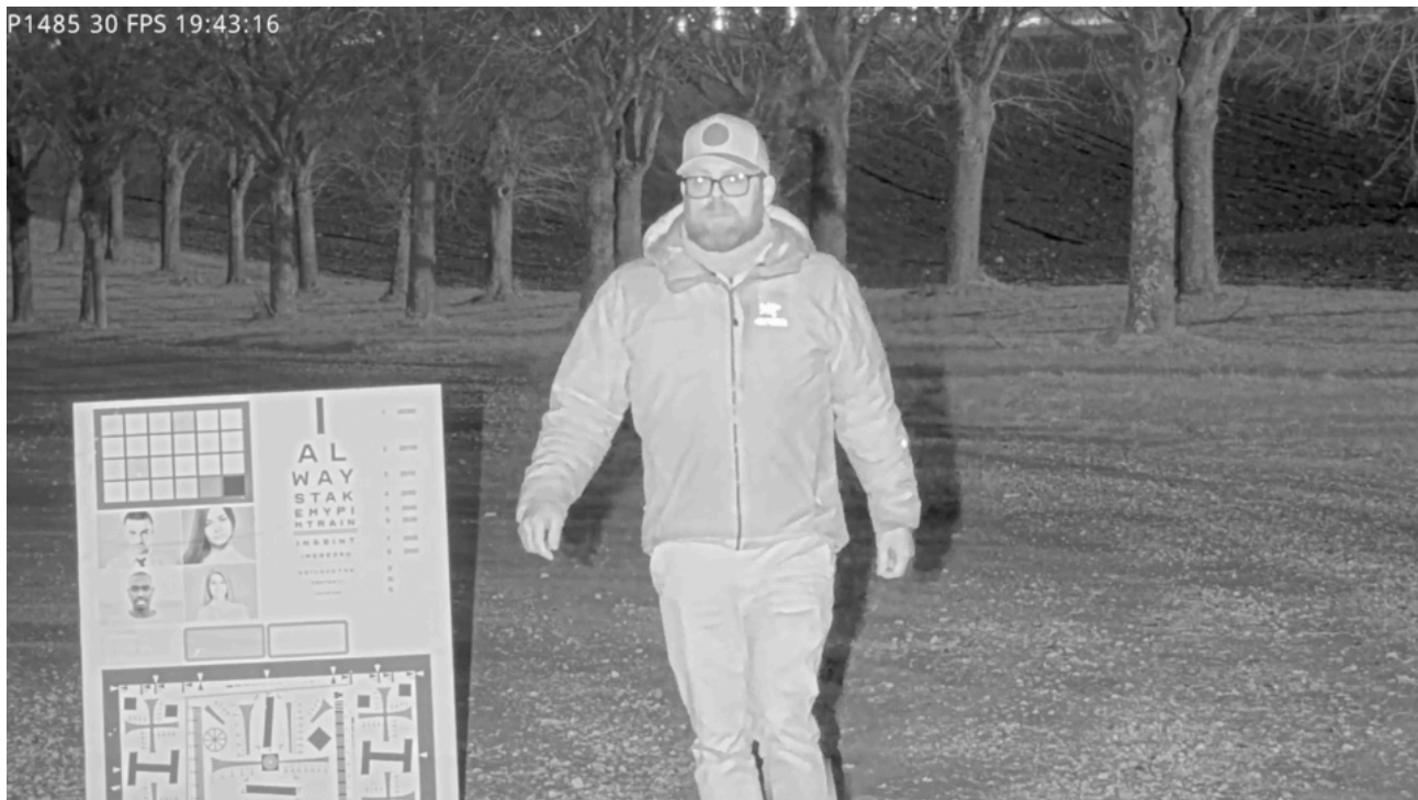
Figure 6.1 Caméra à obturateur progressif avec temps d'exposition long (1/30 s) et flash IR bref (1/1 000 s). Dans ce cas, l'illuminateur IR est visible sur l'image complète, car le flash se déclenche pendant que toutes les lignes du capteur sont exposées simultanément à la lumière.
