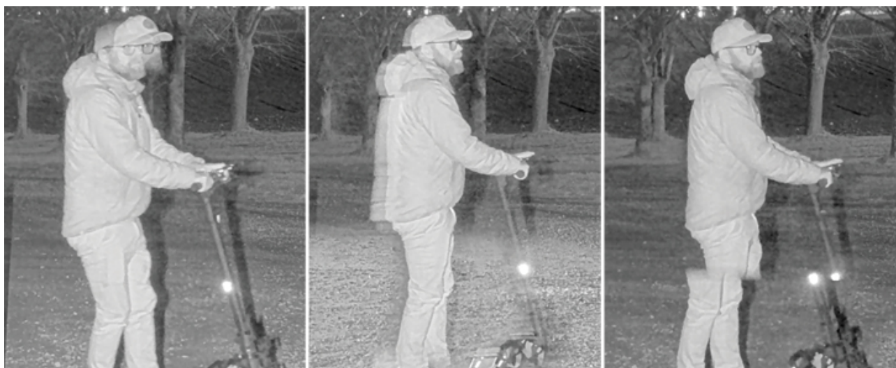
Figure 9.1 Une caméra à obturateur progressif avec temps d'exposition long (1/30 s) à côté d'une caméra à obturateur global avec illuminateur IR stroboscopique en mode WDR. En mode WDR, deux flashes IR sont émis par image, très rapprochés dans le temps. Ces deux impulsions provoquent d'étranges artéfacts d'image sur la caméra à obturateur progressif : images des objets mobiles superposées ou coupées.
