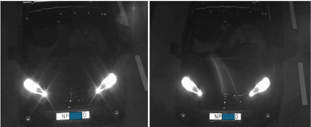
Figure 9.3 Image de voiture capturée avec une caméra à obturateur progressif et une caméra obturateur global, avec temps d'exposition court ( 1/1\ 000 s). Le mouvement à travers l'image étant très lent, on n'observe pas de distorsion due à l'obturateur progressif. Sous cet angle, l'effet « store vénitien » n'est pas perceptible.
