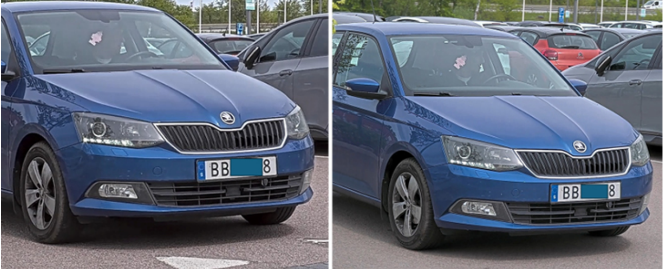
Figure 9.3 Image de voiture capturée avec une caméra à obturateur progressif et une caméra obturateur global, avec temps d'exposition court ( 1/1\ 000 s). Le mouvement à travers l'image étant très lent, on n'observe pas de distorsion due à l'obturateur progressif. Sous cet angle, l'effet « store vénitien » n'est pas perceptible.
