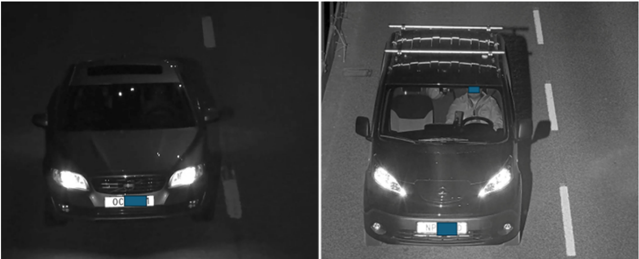
Figura 5.2 La prima immagine mostra un'istantanea di un'automobile scattata con un sensore con otturatore a scorrimento e un illuminatore IR continuo con un consumo energetico di 25 W. La seconda immagine è stata scattata con un sensore con otturatore globale e un illuminatore IR a impulsi con un consumo energetico di 20 W e una potenza di picco di 500 W. L'utilizzo di un sensore con otturatore globale, abbinato a una luce IR intermittente, può migliorare notevolmente la visibilità.
