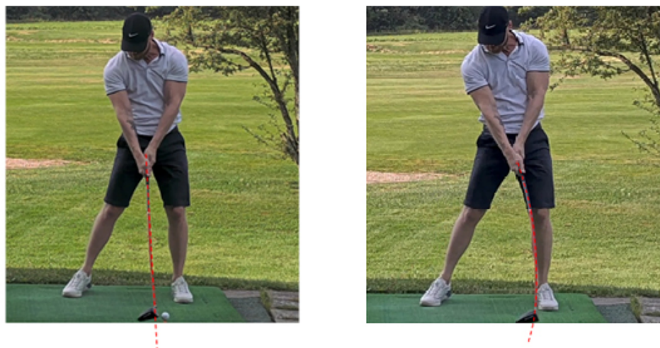
Figura 3.2 Uno swing da golf ripreso nello stesso istante con una telecamera con otturatore a scorrimento (a sinistra) e con una telecamera con otturatore globale (a destra). Nella telecamera con otturatore a scorrimento, il bastone appare storto a causa della distorsione rolling shutter. Entrambe le telecamere hanno impostazioni per tempi di esposizione molto brevi, pari a 1/10000 s, per ridurre al minimo la sfocatura da movimento.
