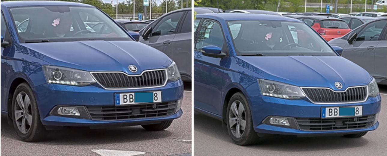
Figura 9.3 Auto ripresa con una telecamera con otturatore a scorrimento e una telecamera con otturatore globale, con un tempo di esposizione breve ( 1/1000 s). Poiché il movimento nell'immagine è molto lento, non si verifica alcuna distorsione rolling shutter. Da questa angolazione, la distorsione rolling shutter non è visibile.
