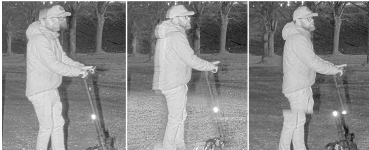
Figura 9.1 Una telecamera con otturatore a scorrimento e tempo di esposizione prolungato (1/30 s) accanto a una telecamera con otturatore globale e luce IR stroboscopica in modalità WDR. In modalità WDR, saranno emessi due flash a infrarossi per fotogramma, a breve distanza l'uno dall'altro. I due impulsi provocano strani artefatti nell'immagine ripresa dalla telecamera con otturatore a scorrimento, quali immagini doppie o immagini troncate degli oggetti in movimento.
