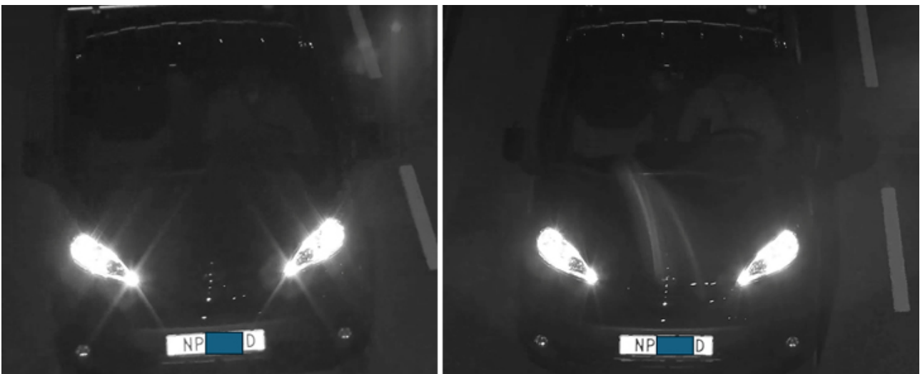
Figura 9.3 Auto ripresa con una telecamera con otturatore a scorrimento e una telecamera con otturatore globale, con un tempo di esposizione breve ( 1/1000 s). Poiché il movimento nell'immagine è molto lento, non si verifica alcuna distorsione rolling shutter. Da questa angolazione, la distorsione rolling shutter non è visibile.
