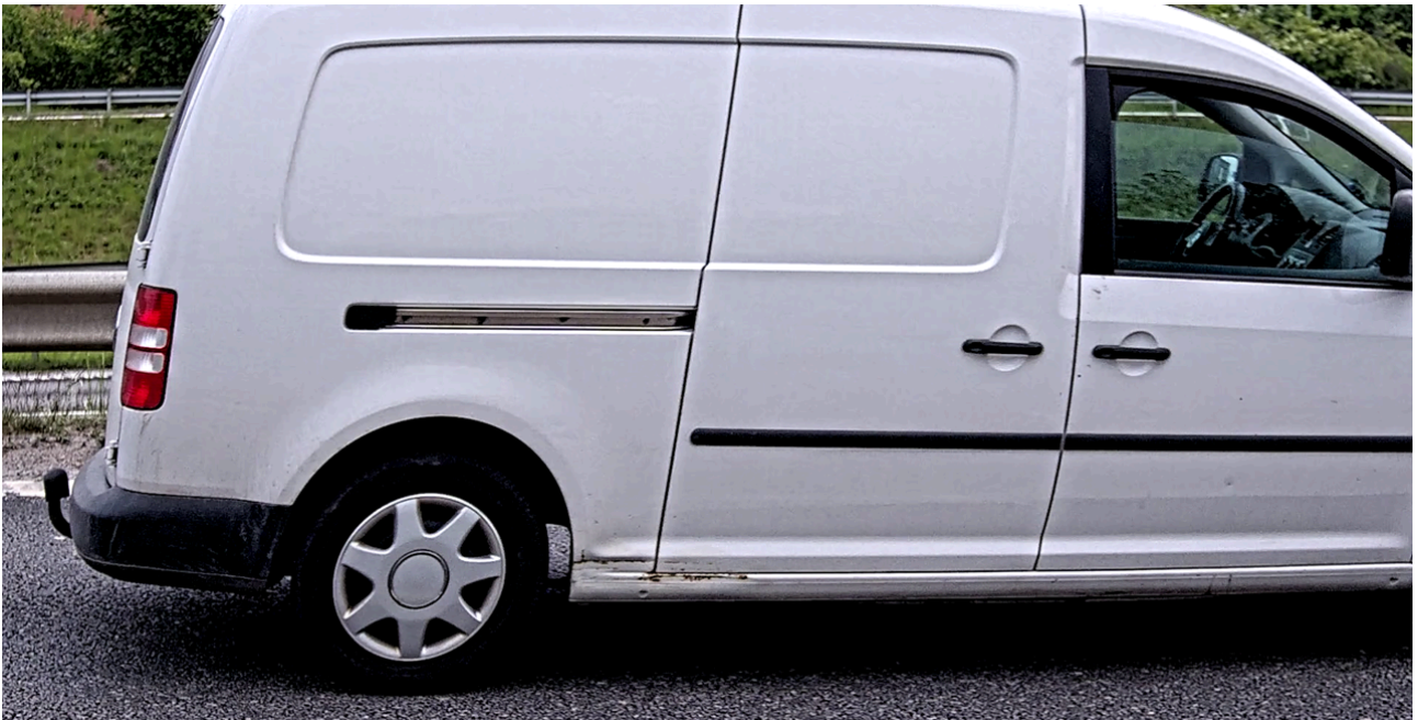
Figura 3.3 Un'auto che attraversa rapidamente l'inquadratura apparirà inclinata a causa della distorsione rolling shutter.
