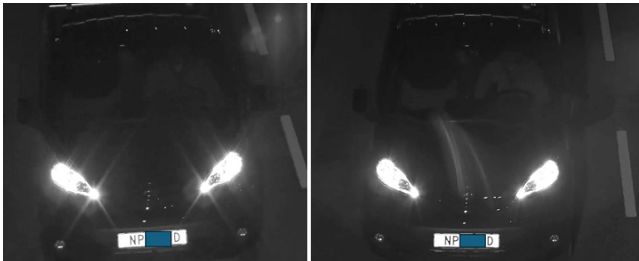
図 9.4 夜間に70 km/hで走行する車両を、20 Wの連続赤外線光源で照らし、ローリングシャッターカメラとグローバルシャッターカメラで短い露光時間 (1/1000秒) を使用して撮影した画像。これらのカメラの光感度とSNRはほぼ同じです。
