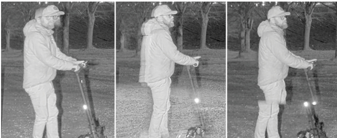
図 9.1 長い露光時間 (1/30秒) に設定したローリングシャッターカメラとWDRモードに設定したストロボ赤外線照明付きのグローバルシャッターカメラを並べて設置。WDRモードでは、1フレームにつき赤外線フラッシュが非常に短い間隔で2回発光します。この2回のパルスにより、ローリングシャッターカメラでは、動く被写体の像が二重になったり欠けたりする不自然な画像の乱れが生じます。
