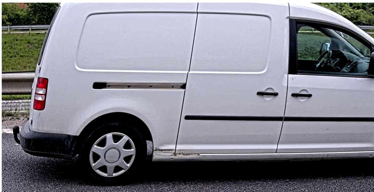
図 3.3 画像上を高速で通過する車両は、ローリングシャッターによる歪みのため、傾いて写ります。
