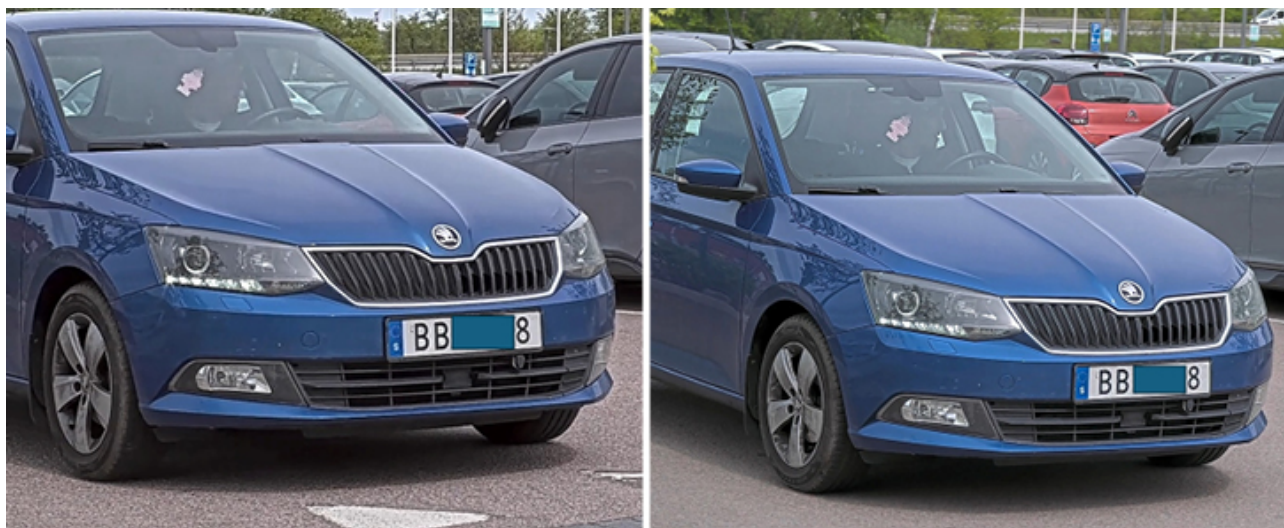
図 9.3 ローリングシャッターカメラとグローバルシャッターカメラで、短い露光時間 (1/1000秒) を使用して撮影した車両。画像上の動きが非常にゆっくりのため、ローリングシャッターによる歪みは生じません。この角度では、ローリングシャッターは確認できません。
