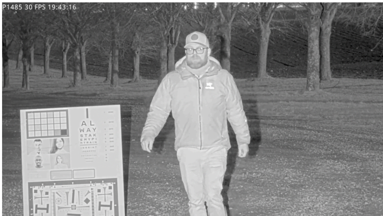
図 6.1 ローリングシャッターカメラで長い露光時間 (1/30秒) と短時間の赤外線フラッシュ (1/1000 秒) を使用した画像。この場合、センサーのすべての行が同時に露光される時間インターバルにフラッシュが発光されるため、赤外線照明が画像全体に写っています。
