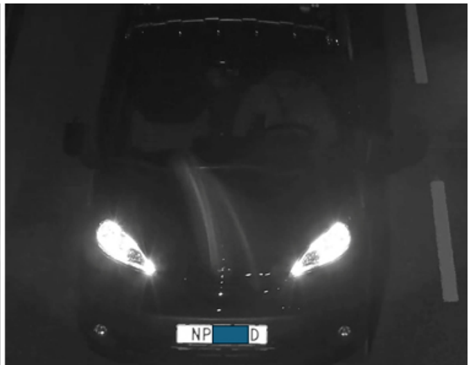
그림 9.4 야간에 70km/h로 주행하는 차량을 20W 연속 IR 광원으로 비추고, 롤링 셔터 카메라와 글로벌 셔터 카메라에서 짧은 노출 시간(1/1000초)을 적용해 촬영한 이미지. 두 카메라의 감광도와 SNR은 대체로 비슷합니다.
