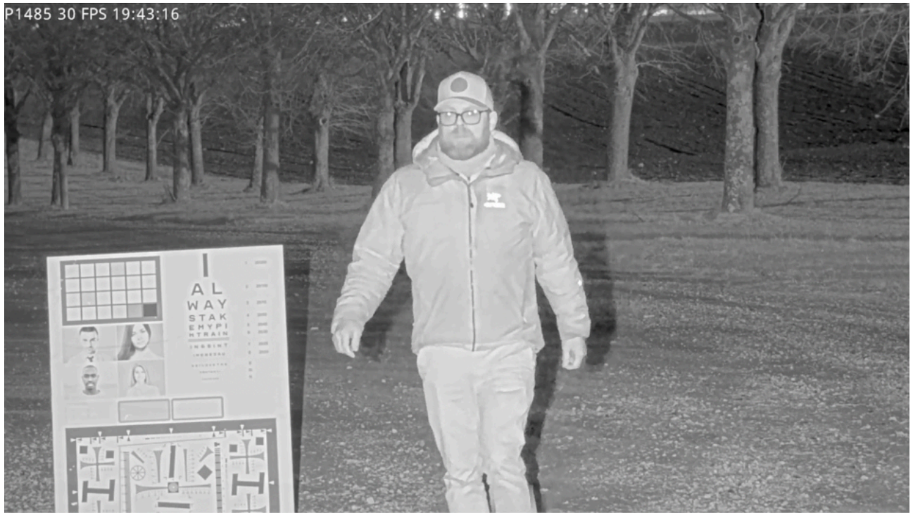
그림 6.1 노출 시간이 긴 롤링 셔터 카메라(1/30초)에 짧은 IR 광 펄스(1/1000초)를 사용한 예시. 이 경우 광 펄스가 센서의 모든 행이 동시에 노출되는 시간 구간에 발생하므로 적외선이 이미지 전체에 나타납니다.
