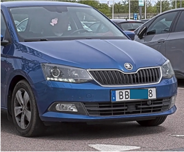
그림 9.3 짧은 노출 시간(1/1000초)을 적용해 롤링 셔터 카메라와 글로벌 셔터 카메라로 촬영한 차량의 이미지. 이미지 안에서 움직임이 매우 느리므로 롤링 셔터 왜곡이 발생하지 않습니다. 이 각도에서는 롤링 셔터 왜곡이 보이지 않습니다.
