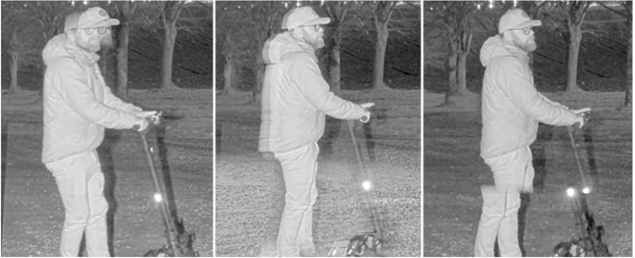
그림 9.1 노출 시간이 긴(1/30초) 롤링 셔터 카메라가 WDR 모드에서 스트로브 적외선을 사용하는 글로벌 셔터 카메라 옆에 설치되어 있습니다. WDR 모드에서는 프레임마다 매우 짧은 간격을 두고 IR 광 펄스가 두 번 발생합니다. 이 두 펄스로 인해 롤링 셔터 카메라에서는 움직이는 객체가 이중으로 보이거나 이미지 일부가 잘린 것처럼 보이는 것과 같은 비정상적인 이미지 아티팩트가 발생합니다.
