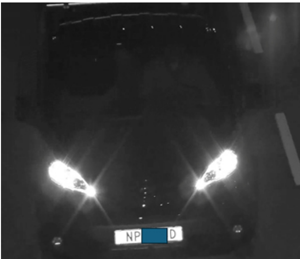
그림 9.4 야간에 70km/h로 주행하는 차량을 20W 연속 IR 광원으로 비추고, 롤링 셔터 카메라와 글로벌 셔터 카메라에서 짧은 노출 시간(1/1000초)을 적용해 촬영한 이미지. 두 카메라의 감광도와 SNR은 대체로 비슷합니다.
