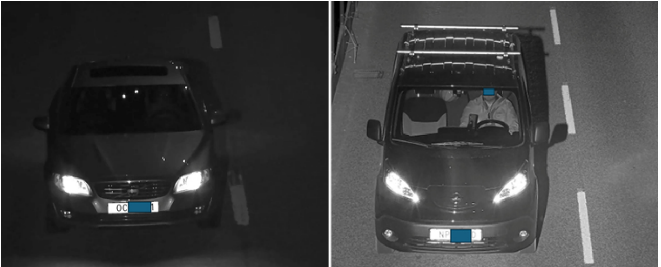
그림 5.2 첫 번째 이미지는 롤링 셔터 센서와 소비 전력 25W의 연속 IR 조명기를 사용해 촬영한 차량의 이미지입니다. 두 번째 이미지는 글로벌 셔터 센서와 평균 소비 전력 20W, 순간 최대 전력 500W의 스트로브 IR 조명기를 사용해 촬영했습니다. 글로벌 셔터 센서와 스트로브 적외선을 함께 사용하면 객체의 식별성을 크게 높일 수 있습니다.
