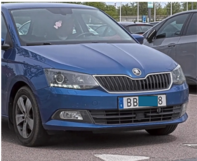
Ilustracja 9.3 Samochód uchwycony przez kamerę z migawką kroczącą oraz kamerę z migawką globalną przy krótkim czasie ekspozycji (1/1000 s). Ponieważ ruch na obrazie jest bardzo wolny, nie występują zniekształcenia spowodowane efektem migawki kroczącej. Pod tym kątem efekt ten jest niewidoczny.
