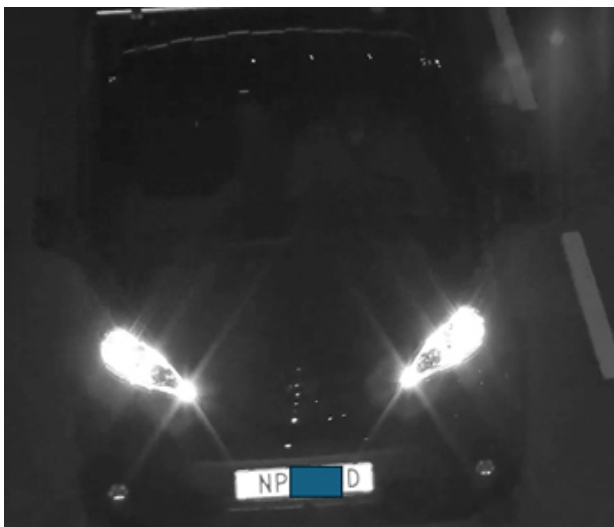
Ilustracja 9.4 Samochód poruszający się z szybkością 70 km/h w nocy oświetlony ciągłą podczerwienią z oświetlacza o mocy 20 W uchwycony przez kamerę z migawką kroczącą i kamerę z migawką globalną przy krótkim czasie ekspozycji (1/1000 s). Kamery mają mniej więcej taką samą czułość i stosunek sygnału do szumu.
