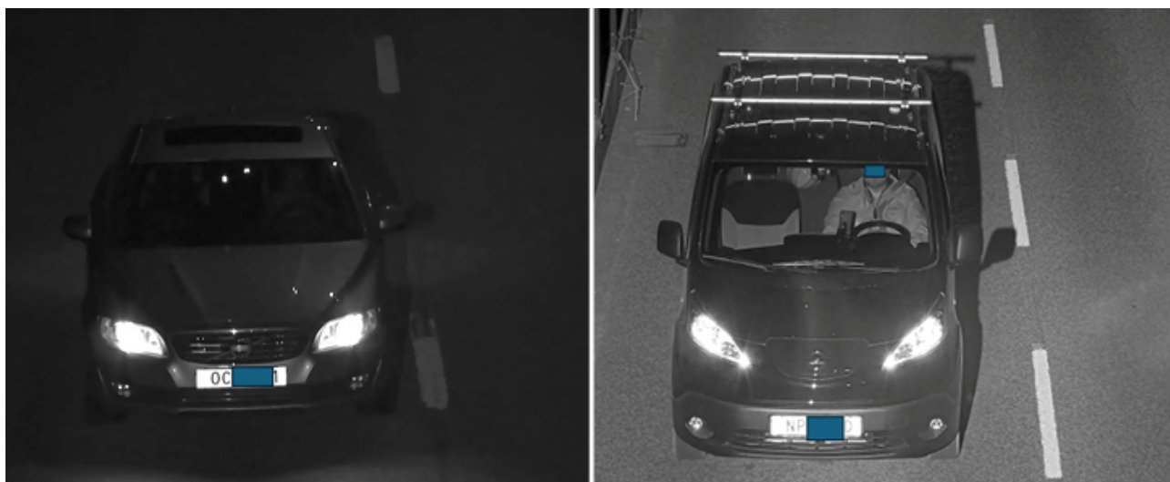
Ilustracja 5.2 Pierwszy obraz to ujęcie samochodu wykonane przy użyciu przetwornika obrazu z migawką kroczącą oraz ciągłego oświetlacza podczerwieni o poborze mocy 25 W. Drugi uzyskano przy użyciu przetwornika obrazu z migawką globalną oraz stroboskopowego oświetlacza podczerwieni o poborze mocy 20 W i mocy szczytowej 500 W. Zastosowanie przetwornika obrazu z migawką globalną w połączeniu ze stroboskopowym oświetleniem podczerwieni może znacząco poprawić widoczność.
