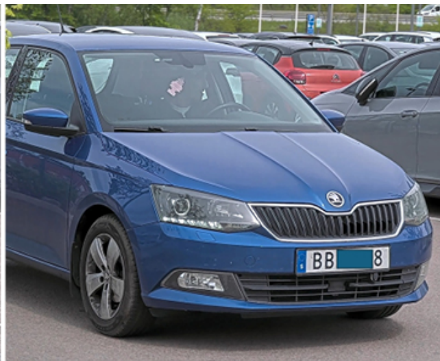
Ilustracja 9.3 Samochód uchwycony przez kamerę z migawką kroczącą oraz kamerę z migawką globalną przy krótkim czasie ekspozycji (1/1000 s). Ponieważ ruch na obrazie jest bardzo wolny, nie występują zniekształcenia spowodowane efektem migawki kroczącej. Pod tym kątem efekt ten jest niewidoczny.
