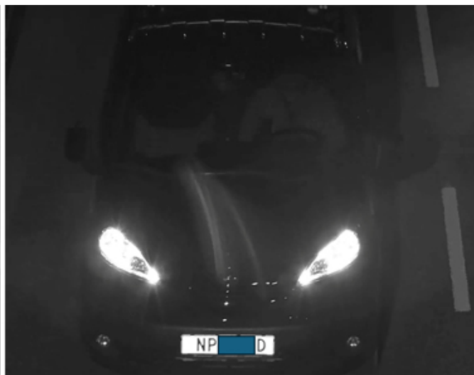
Ilustracja 9.4 Samochód poruszający się z szybkością 70 km/h w nocy oświetlony ciągłą podczerwienią z oświetlacza o mocy 20 W uchwycony przez kamerę z migawką kroczącą i kamerę z migawką globalną przy krótkim czasie ekspozycji (1/1000 s). Kamery mają mniej więcej taką samą czułość i stosunek sygnału do szumu.
