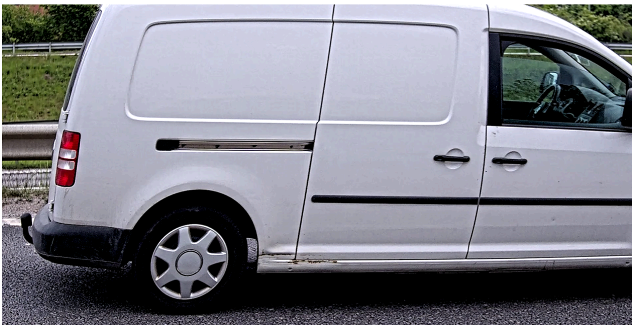
Ilustracja 3.3 Szybko przemieszczający się samochód wyda się przechylony z powodu zniekształcenia spowodowanego efektem migawki kroczącej.
