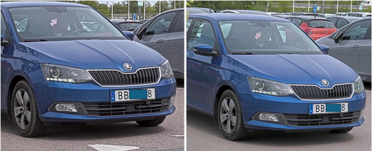
Figura 9.3 Veículo capturado com uma câmera de obturador móvel e uma câmera de obturador global, com tempo de exposição curto ( 1/1.000 s). Como o movimento na imagem é muito lento, não há distorção de obturador móvel. Nesse ângulo, o obturador móvel não é visível.
