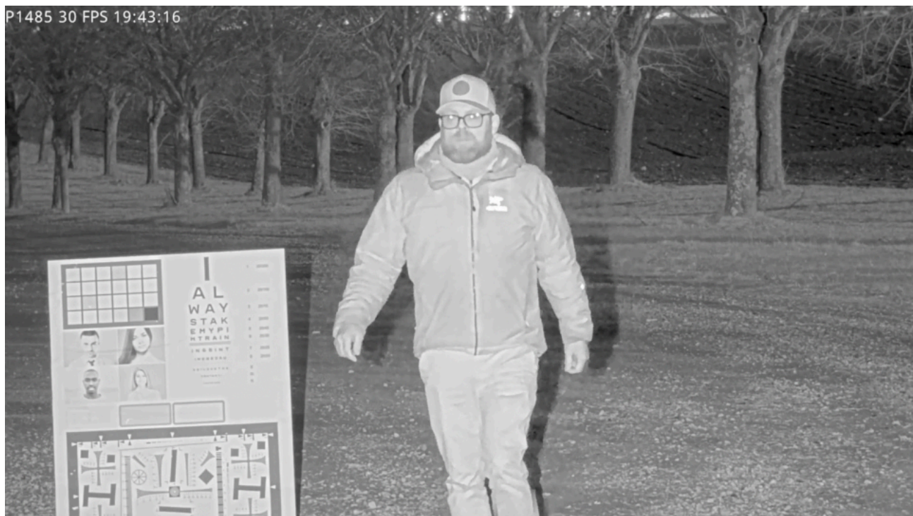
Figura 6.1 Uma câmera com obturador móvel com tempo de exposição longo (1/30 s) e um flash infravermelho curto (1/1.000 s). A luz infravermelha, nesse caso, é visível na imagem completa, uma vez que o flash ocorre no tempo em que todas as linhas do sensor são expostas simultaneamente à luz.
