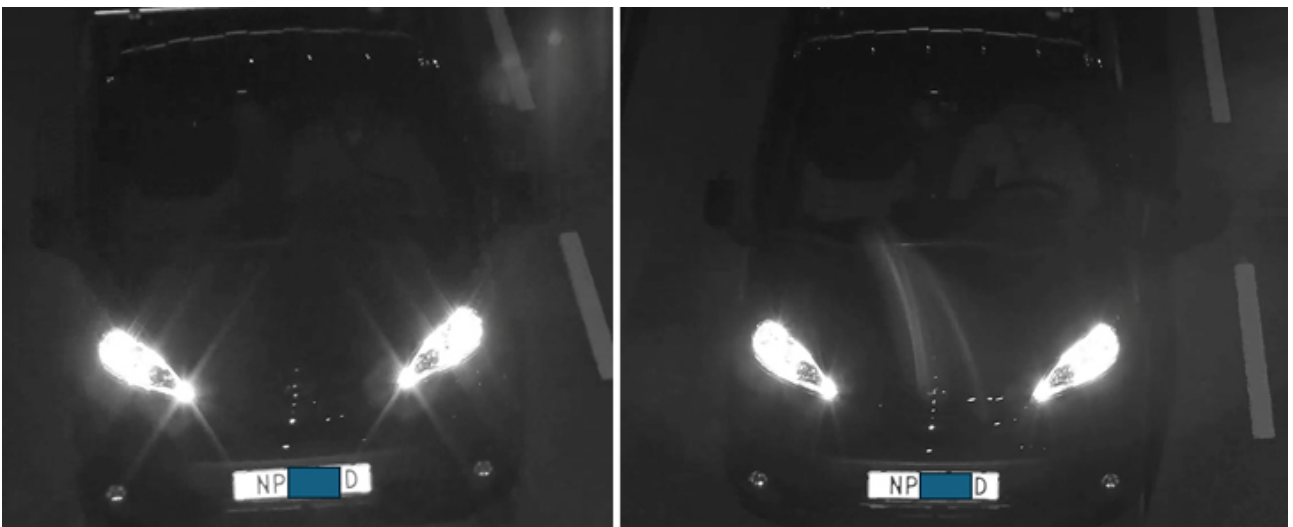
Figura 9.3 Veículo capturado com uma câmera de obturador móvel e uma câmera de obturador global, com tempo de exposição curto ( 1/1.000 s). Como o movimento na imagem é muito lento, não há distorção de obturador móvel. Nesse ângulo, o obturador móvel não é visível.
