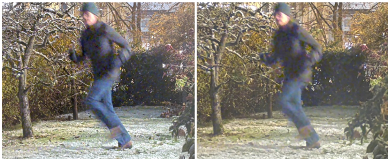
Figura 9.5 Uma pessoa correndo, capturada por uma câmera com obturador móvel e por uma câmera com obturador global à noite, com tempos de exposição longos (1/25 s). O longo tempo de exposição causa desfoque por movimento em ambas as câmeras.
