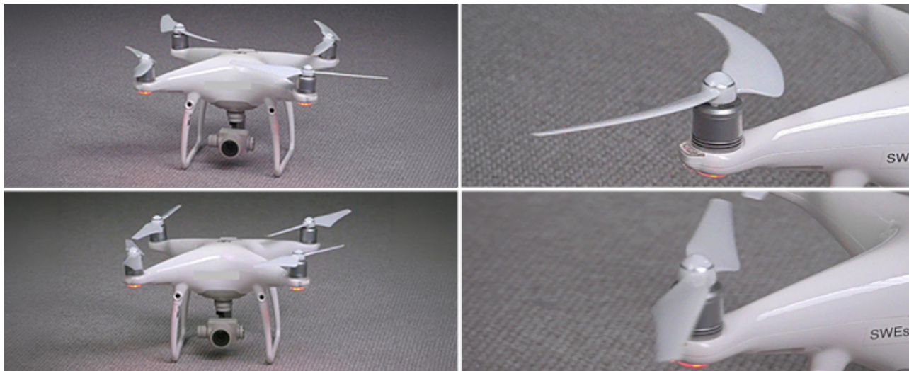
Figura 3.1 As duas primeiras imagens mostram um drone fotografado por uma câmera com obturador móvel. As pás da hélice estão deformadas e é difícil adivinhar qual é a sua forma original. As duas imagens a seguir apresentam o mesmo drone capturado por uma câmera com obturador global. A imagem apresenta a forma real das pás. Ambas as câmeras têm um tempo de exposição muito curto, de 1/10.000s , para minimizar o desfoque por movimento.
