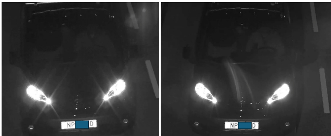
图 9.4 夜间，车辆以 70 千米/小时速度行驶，搭配 20 瓦持续红外常亮补光；分别采用卷帘快门、全局快门摄像机以 1/1000 秒短曝光时长进行拍摄。两台摄像机感光灵敏度、图像信噪比基本一致。
