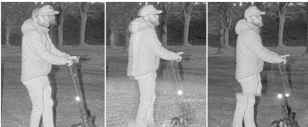
图 9.1 一台卷帘快门摄像机采用长曝光时长（1/30 秒），旁边搭配一台开启宽动态模式、使用红外频闪补光的全局快门摄像机。宽动态模式下，每帧画面会输出两次间隔极短的红外闪光脉冲。两组闪光脉冲会让卷帘快门摄像机拍出异常画面伪影，运动物体出现重影、画面截断等问题。
