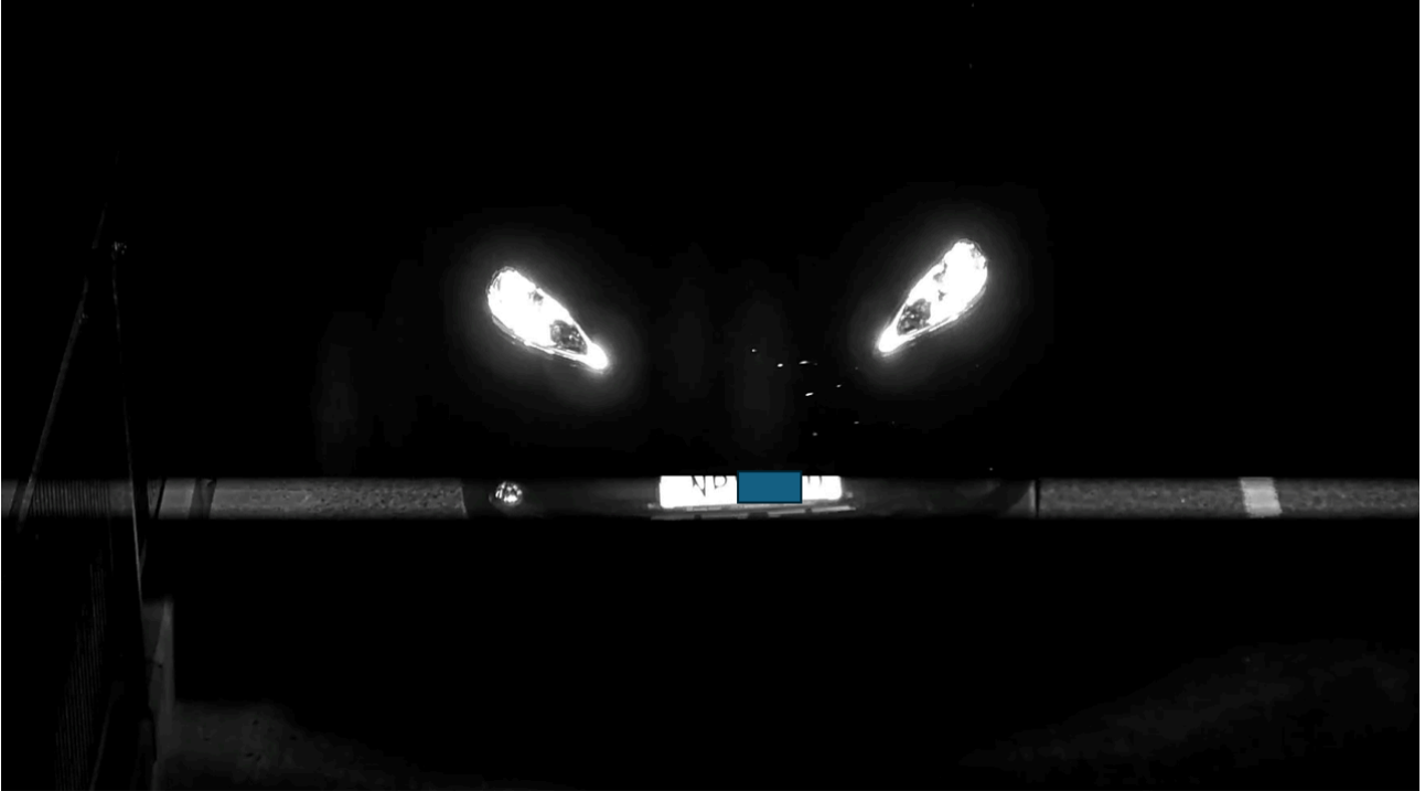
图 6.2 卷帘快门传感器以 1/1000 秒（1 毫秒）曝光时长拍摄行驶中的车辆。另一台摄像机配套大功率红外频闪补光灯，脉冲时长 0.5 毫秒，同场景拍摄的画面中出现明显横向亮带。
