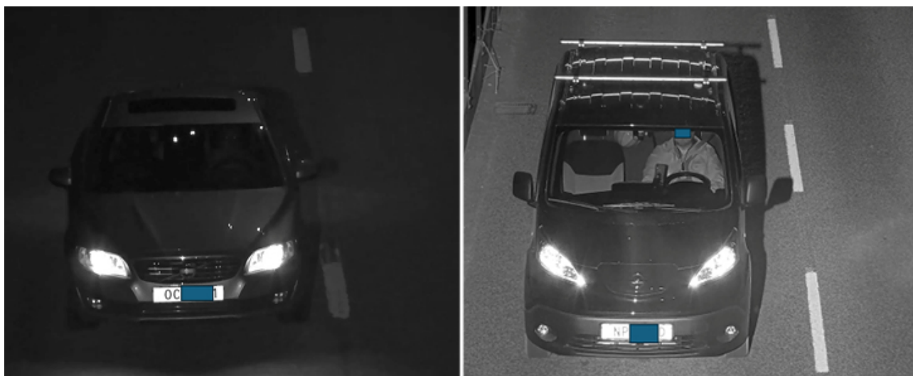
图 5.2 第一张图片为卷帘快门传感器搭配 25 瓦常亮红外补光灯拍摄的车辆实拍图；第二张图片采用全局快门传感器，搭配平均功耗 20 瓦、峰值功率 500 瓦的频闪红外补光灯拍摄。全局快门传感器搭配频闪红外光源，可大幅提升画面可视效果。
