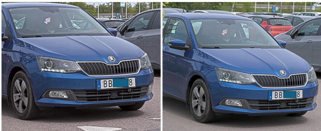
图 9.3 使用短曝光时长（ 1/1000 秒），分别用卷帘快门、全局快门摄像机拍摄的行驶车辆。车辆在画面内像素位移速度极低，不存在卷帘快门畸变；该拍摄角度下卷帘快门畸变完全不可见。
