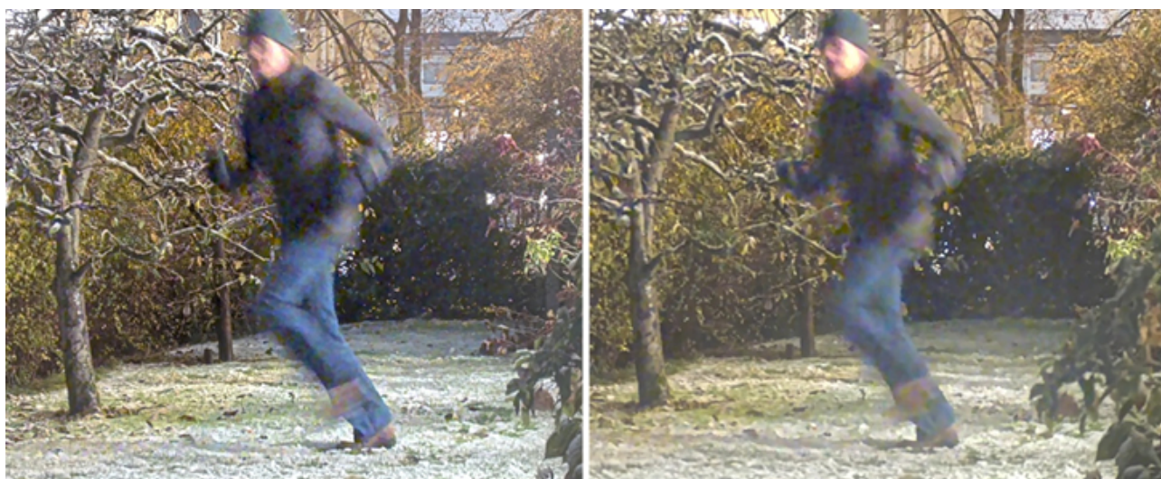
图 9.5 夜间长曝光（ 1/25 秒）模式下，分别使用卷帘快门摄像机与全局快门摄像机拍摄奔跑的行人；两种相机都会因长曝光产生运动模糊。
