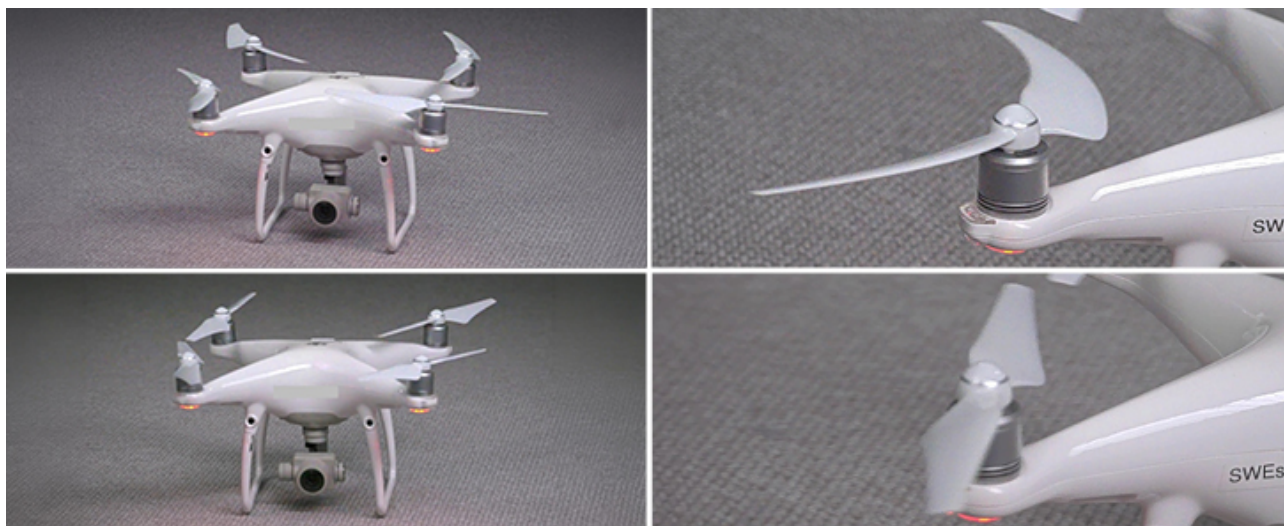
图 3.1 前两张附图为卷帘快门摄像机拍摄的无人机画面：螺旋桨叶片严重畸变，难以辨识真实轮廓。后两张附图为同一台无人机、采用全局快门摄像机拍摄的画面：可清晰还原叶片真实外形。两台摄像机均采用 1/10000 秒极短曝光时长，最大限度消除运动模糊。
