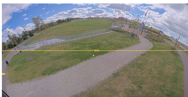
180 Grad Panorama-Schnappschüsse, aufgenommen von einer Mehrfachsensorkamera. Links: Ohne Horizontglättung ist das Bild um die Mittellinie der Kameraansicht (gelb markiert) gekrümmt. Wegen der nach unten geneigten Kamera liegt diese Linie nicht auf dem Horizont. Rechts: Horizontglättung gleicht die Abwärtsneigung der Kamera aus, das Bild wird um den Horizont herum projiziert.
