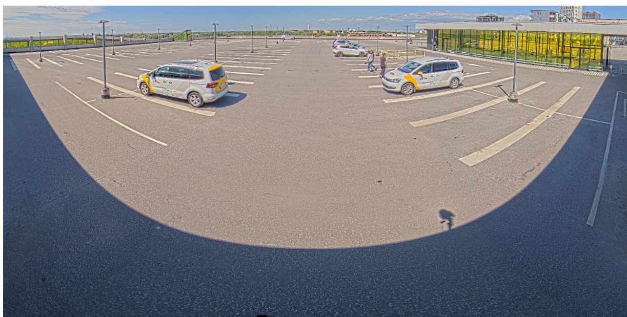
180 Grad Panorama-Schnappschüsse, aufgenommen von einer Mehrfachsensorkamera mit Horizontglättung. Der Horizont ist gerade, senkrechte Objekte sind senkrecht.
