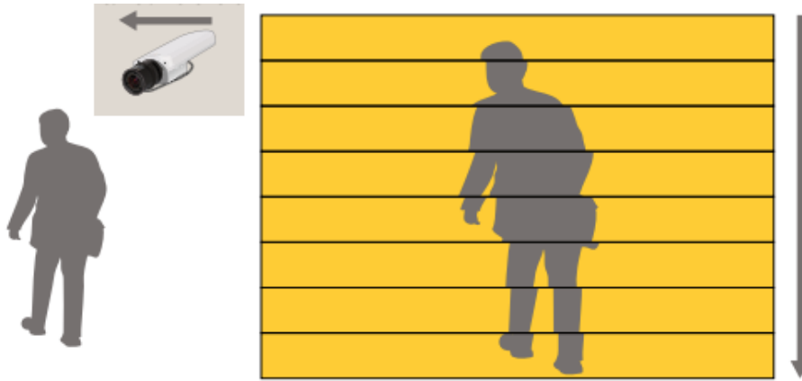
Abbildung 5.1 Das Prinzip der Rolling-Shutter-Verzerrung: Der Sensor liest das Bild zeilenweise von oben nach unten. Wenn sich die Kamera aufgrund von Vibrationen leicht nach links bewegt, während die Zeilen ausgelesen werden, wird das Bild verzerrt.
