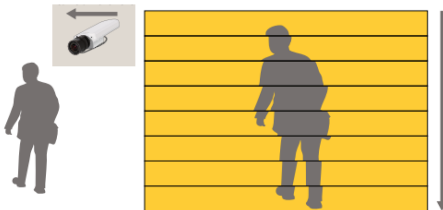
Figure 2. El principio de la distorsión por obturador basculante. La lectura de las líneas desde el sensor se produce de arriba abajo en la imagen. Si a causa de las vibraciones la cámara se desplaza ligeramente a la izquierda durante la lectura de las líneas, el resultado es una imagen con aberración esférica.
