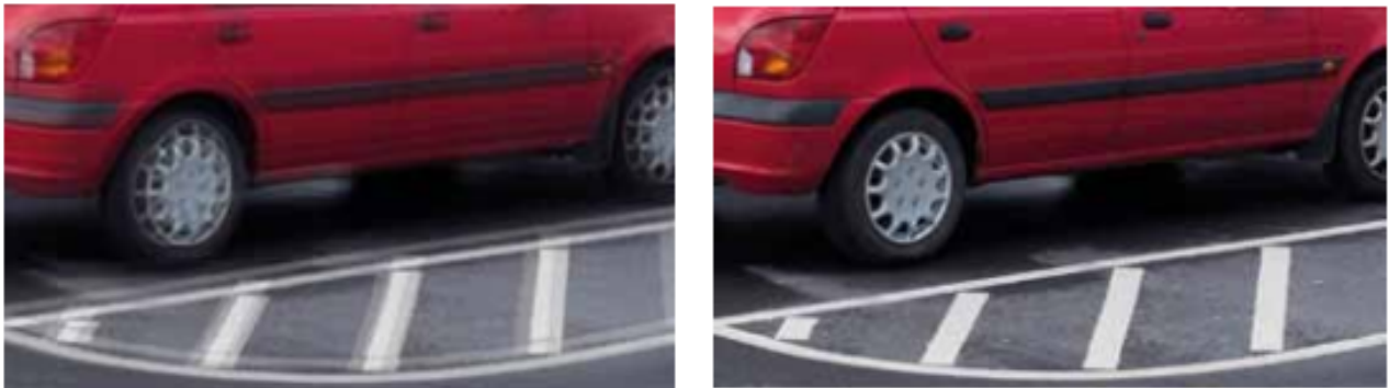
Figura 4.1 Imágenes simuladas. Izquierda: un primer plano sin estabilización de imagen electrónica, con presencia de distorsión por movimiento horizontal y vertical. Derecha: una instantánea de la cámara sometida a vibraciones con estabilización de imagen electrónica activada.
