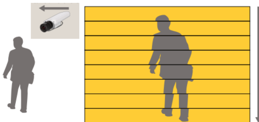
Figure 5.1 Le principe de la distorsion de l'obturateur déroulant. Les lignes sont lues par le capteur du haut vers le bas de l'image. Lorsque les vibrations entraînent un léger déplacement de la caméra vers la gauche pendant le balayage des lignes, l'image est déformée.
