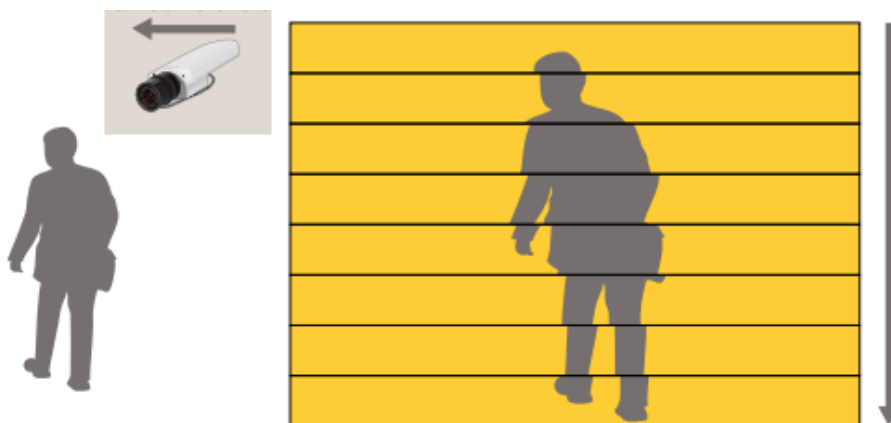
Figura 5.1 Il principio della distorsione da scansione lineare. Le righe vengono lette dal sensore dal lato superiore al lato inferiore dell'immagine. Quando la vibrazione fa spostare leggermente la telecamera a sinistra durante la lettura delle righe, il risultato è un'immagine distorta.
