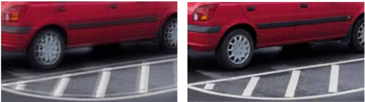
Figura 4.1 Immagini simulate. A sinistra: primo piano senza stabilizzatore elettronico dell'immagine. Si evidenzia la sfocatura da movimento orizzontale e verticale. A destra: istantanea della telecamera che vibra con lo stabilizzatore elettronico dell'immagine attivato.
