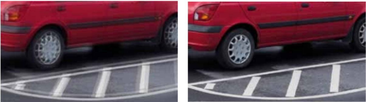
Figure 1. 시뮬레이션 이미지. 왼쪽: 흔들림 보정을 사용하지 않은 클로즈업 사진으로, 수평 및 수직 모션 블러가 모두 표시됩니다. 오른쪽: 흔들림 보정을 활성화한 상태에서 진동 카메라로 촬영한 스냅샷입니다.
