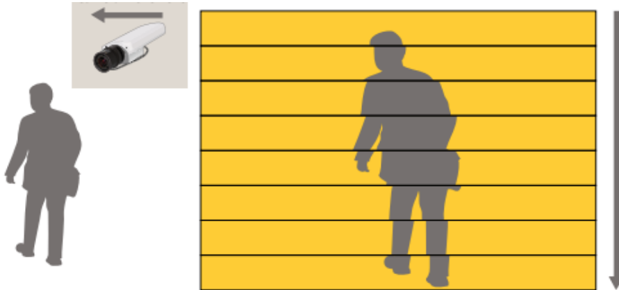
Figure 2. 롤링 셔터 왜곡의 원리. 센서가 라인을 이미지의 위쪽에서 아래쪽으로 판독합니다. 라인을 판독하는 동안 진동으로 인해 카메라가 왼쪽으로 약간 움직이면 이미지가 왜곡됩니다.
