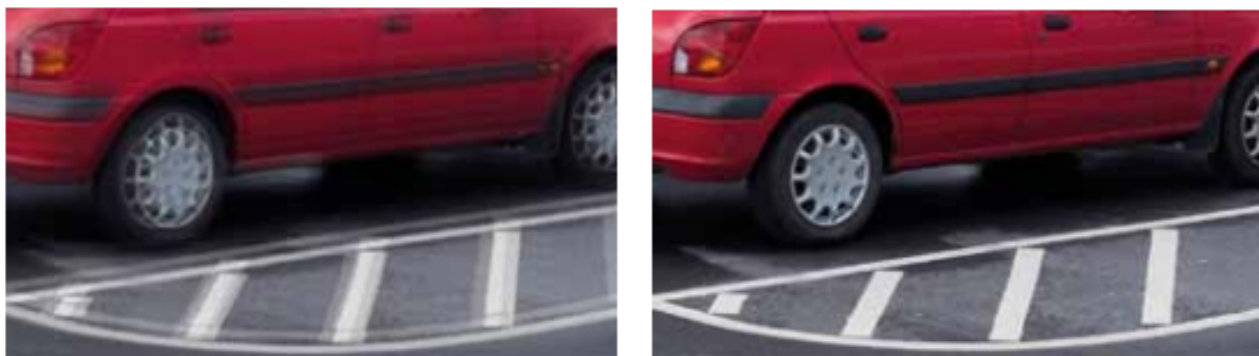
Ilustracja 4.1 Obrazy symulowane. Po lewej: zbliżenie bez elektronicznej stabilizacji obrazu, z widocznym rozmyciem obrazu w poziomie i w pionie. Po prawej: zdjęcie z drgającej kamery z elektroniczną stabilizacją obrazu.
