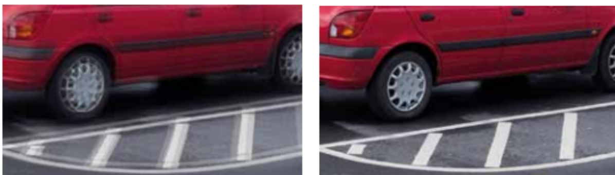
Figure 1. Imagens simuladas. Esquerda: close-up sem estabilização eletrônica de imagem, mostrando desfoque de movimento horizontal e vertical. Direita: instantâneo da câmera vibrando com estabilização eletrônica de imagem ativada.
