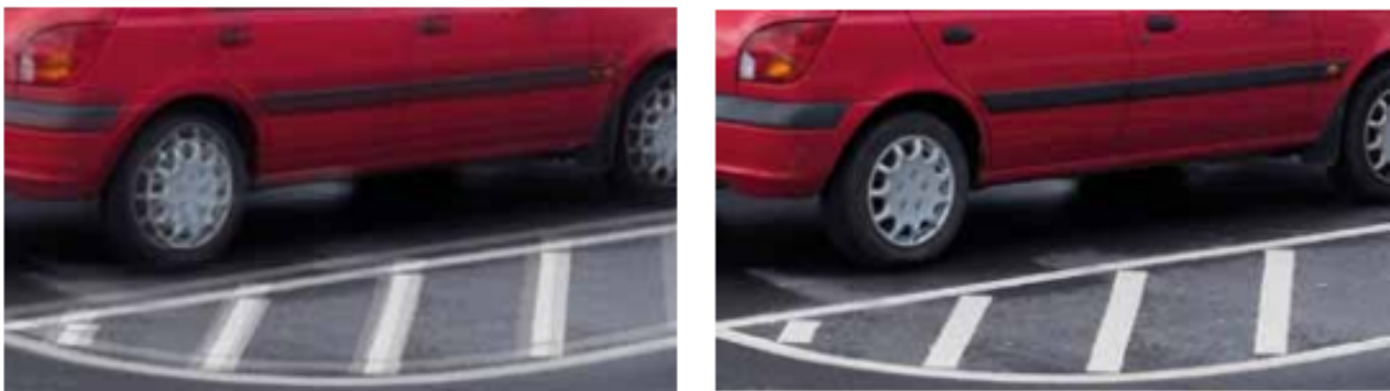
Figura 4.1 Imagens simuladas. Esquerda: close-up sem estabilização eletrônica de imagem, mostrando desfoque de movimento horizontal e vertical. Direita: instantâneo da câmera vibrando com estabilização eletrônica de imagem ativada.
